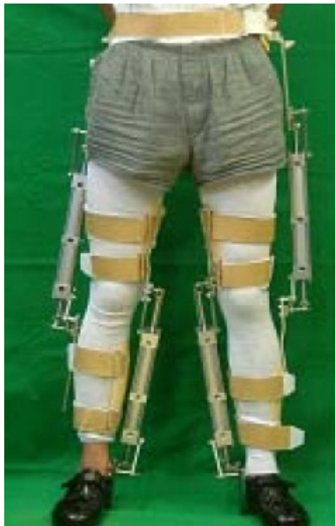
Figura 3.27: Órtese ativa com atuadores hidráulicos desenvolvida na Universidade Denkai, [Saito 2005].
