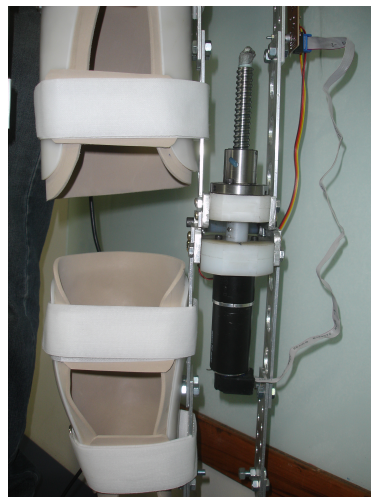
Figura 4.4: Calhas de polipropileno usadas para fixar a órtese no usuário.
