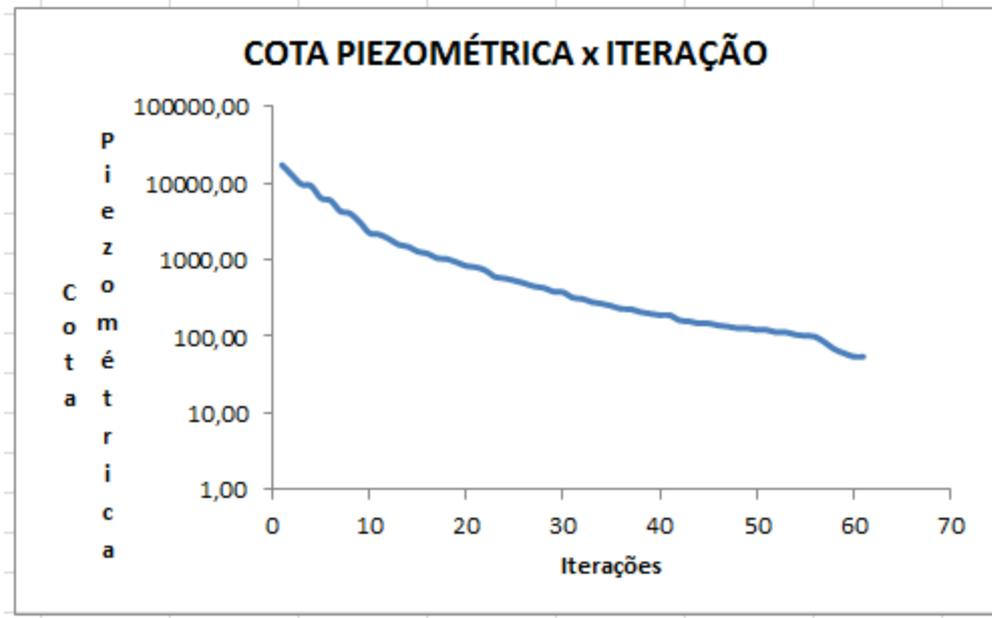
**Figura 4.31 – Cota Piezométrica de Cabeceira x Iteração**
