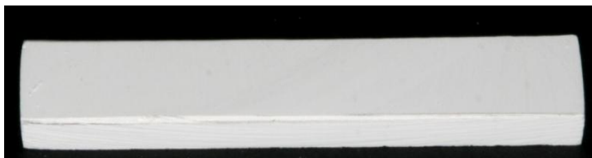
Figura 13 – Dimensões da barra de Y-TZP após sinterização: 20 mm de comprimento; 4 mm de largura; 1,2 mm de espessura.
