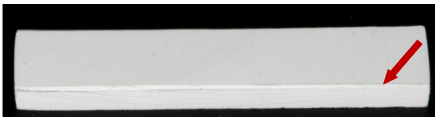
Figura 12 – Barra de Y-TZP com biselamento das bordas antes da sinterização.
