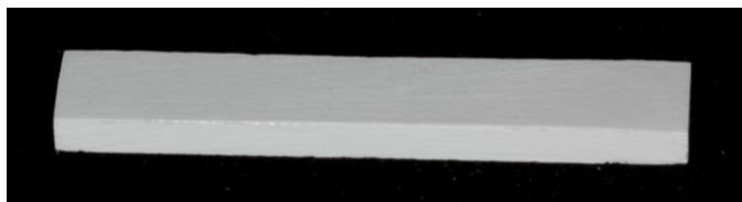
Figura 11 – Representação ilustrativa da barra de Y-TZP pré-sinterizada obtida após corte. Dimensões: 25 mm comprimento; 5 mm largura; 1,6 mm espessura.
