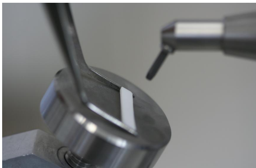
Figura 16 – Jateamento da amostra com distância de 10 mm, 2,8 bars de pressão por 10 s e ângulo de incidência de 90^{\circ} .
