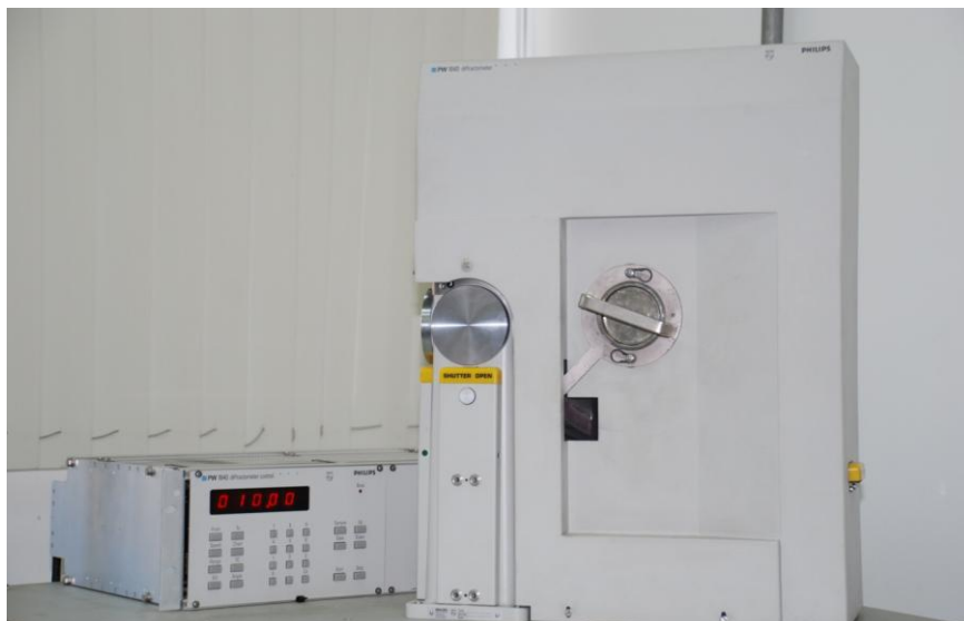
Figura 20- Difrator de Raios-X de alta resolução Philips X'Pert MRD (Laboratório Associado de Sensores e Materiais- LAS/INPE 1 ).
