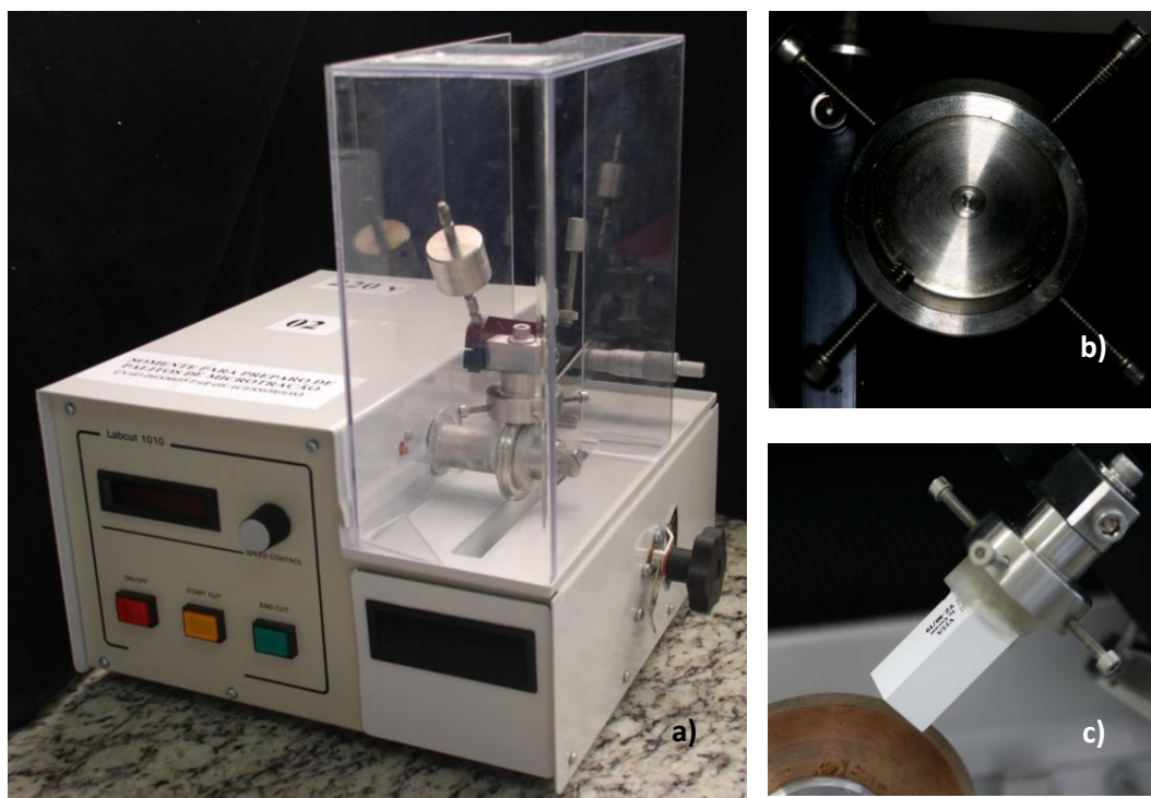
Figura 8 – a) Máquina de corte (LabCut); b) Dispositivo por onde se acopla a base do bloco de RAAQ; c) Posição do bloco de zircônia sobre o disco diamantado.
