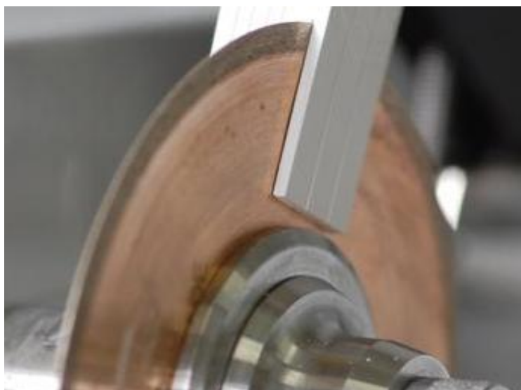
Figura 10 – Corte dos blocos de Y-TZP: obtenção de 7 fatias de 1,6 mm de espessura.
