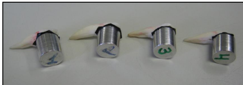
Fig.17 “Stubs” suportes metálicos para leitura no MEV, os espécimes fica aderido a eles com uma fita de carbono de dupla face (OLIVEIRA-SAMPAIO, 2010)
