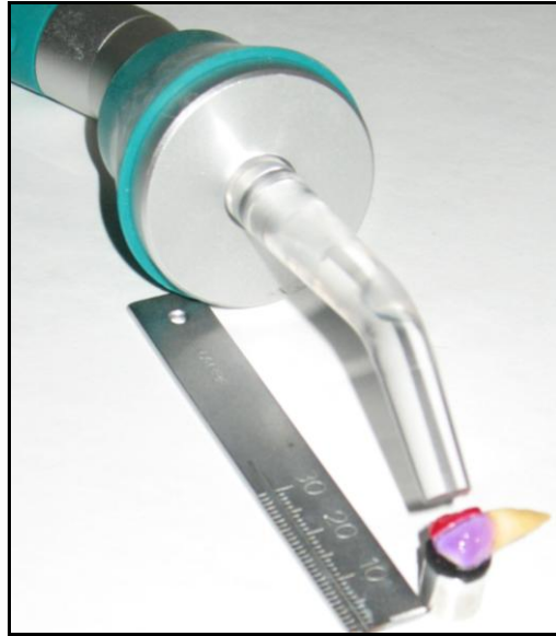
Fig.12 Distância de 5mm do aparelho LED verde em relação ao agente clareador no espécime, régua milimetrada usada para confirmar a distância, vista frontal (OLIVEIRA-SAMPAIO, 2010)
