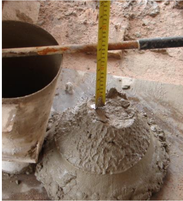
Figura 55 - Conferência do abatimento aceitável para o recebimento do concreto
