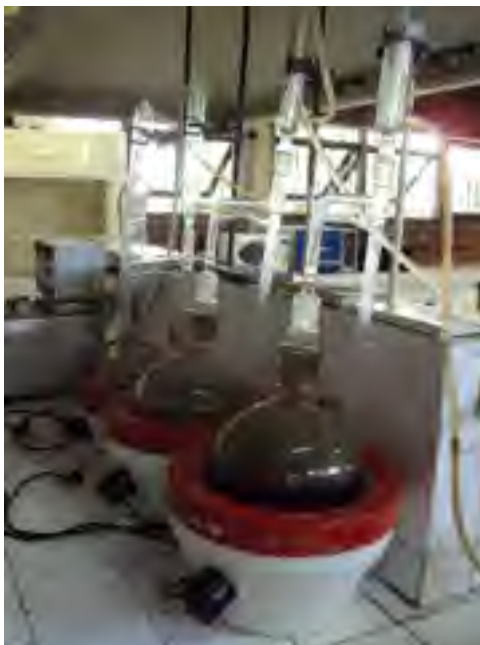
Figura 5 Aparelho do tipo Clevenger utilizado na obtenção dos óleos essenciais das espécies de Protium .
