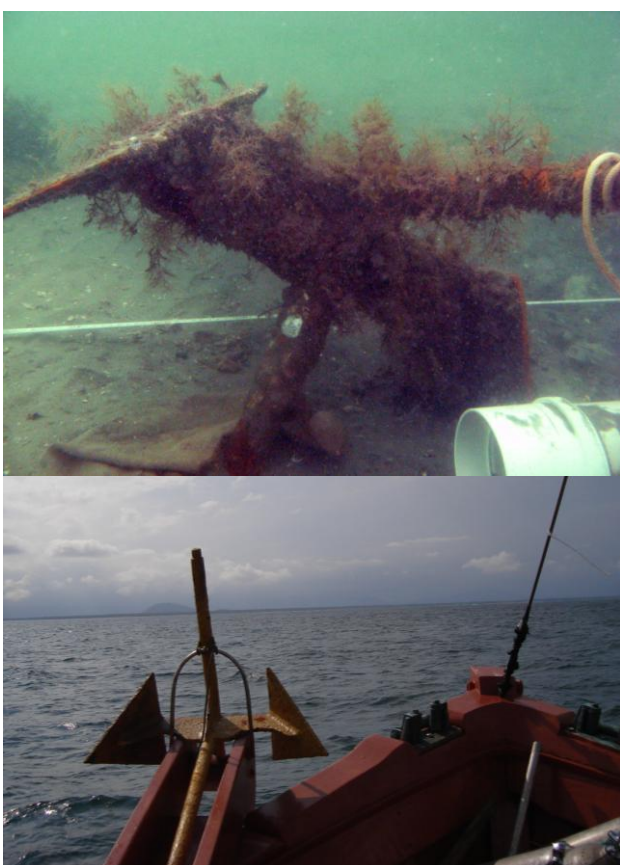
Imagem 70 - Visão da âncora tipo Patente (II) garrada ao fundo da enseada. Na imagem logo abaixo pode-se observar modelo idêntico preso na proa da embarcação de pesquisa Albacora
