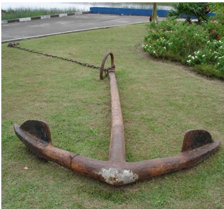
Imagem 129 – Modelo de âncora de haste e braços de ferro e encaixe para cepo de madeira
