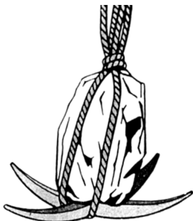
Imagem 117 - Desenho de âncora de pedra. Fonte: Dicionário Ilustrado de navegação a vela (1971, p. 23)
