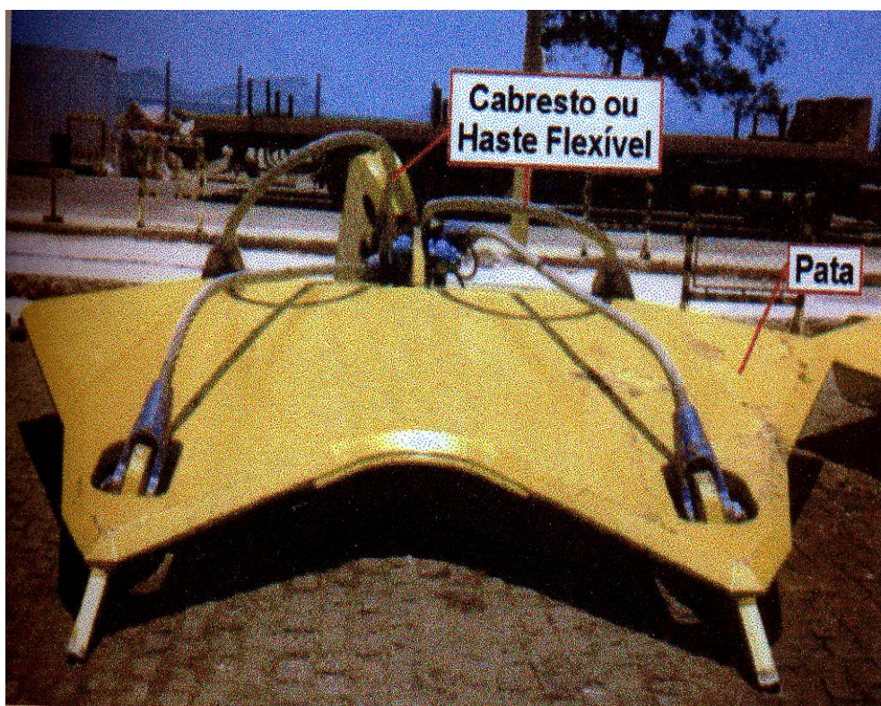
Imagem 156 - Modelo de uma âncora oceânica STEVMANTA de 13m 2 Fonte: Domínguez (2002, p. 23)
