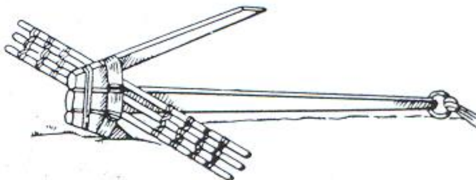
Imagem 119 - Desenho do modelo de uma âncora chinesa de bambu. Fonte: Martínez (1957, p. 233)
