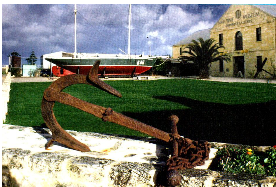
Imagem 138 - Âncora Porter, articulada e com cepo. Fonte: Folder da University of Western Australian
