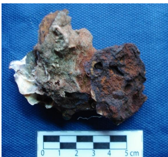
Imagem 106 – Aspecto de amostra da concreção após ser retirada da solução de H 2 O 2 (10%)
