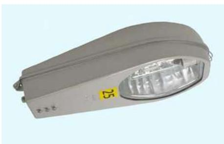
Exemplo da nova luminária utilizada nos postes altos no centro. O refletor é de alumínio metalizado e garante alto rendimento. Possui um visor em vidro transparente plano que produz um fecho mais preciso, projetando mais luz para baixo e evitando poluição luminosa, porém, comprometendo a reprodução do entorno.
