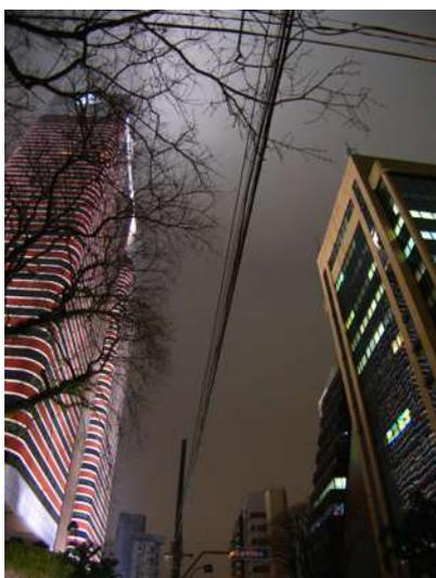
Nota-se o edifício em frente iluminado pela luz excedente dos projetores indiretos do Hotel Renaissance, equipados com uma lâmpada de multi-vapor metálico de 1.500W cada, comprometendo o conforto de seus ocupantes.
