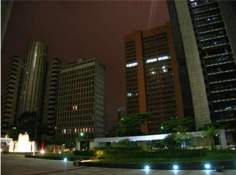
Edifícios vizinhos (lado contrário da via) iluminados pela luz excedente dos projetores do condomínio devido à excessiva abertura de fecho dos equipamentos e à alta intensidade das fontes. Nota-se, também, a alta temperatura de cor usada nos balizadores embutidos nas laterais dos canteiros em desacordo com a luminosidade no local.
