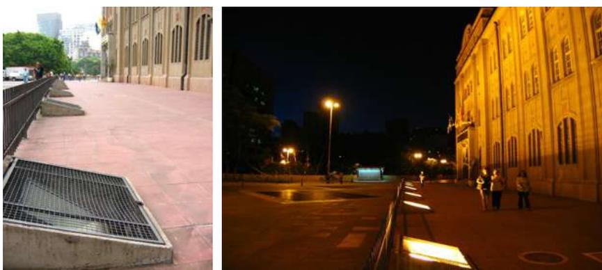
Projetores que iluminam a fachada do mosteiro, instalados dentro de nichos criados no piso. Devido à projeção de luz frontal, há grande parcela de luz invasiva nos ambientes internos.
