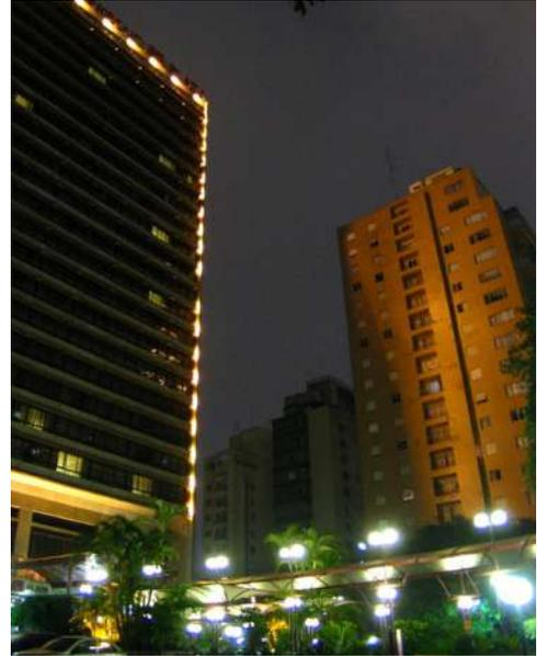
Edifícios vizinhos ao hotel com suas fachadas iluminadas pela luz excedente dos projetores fixados nos limites da arquitetura (laterais e topo). Nota-se, também, a falta de compatibilização entre as temperaturas de cor utilizadas na fachada (2.000K) e nas marquises (4.000K).
