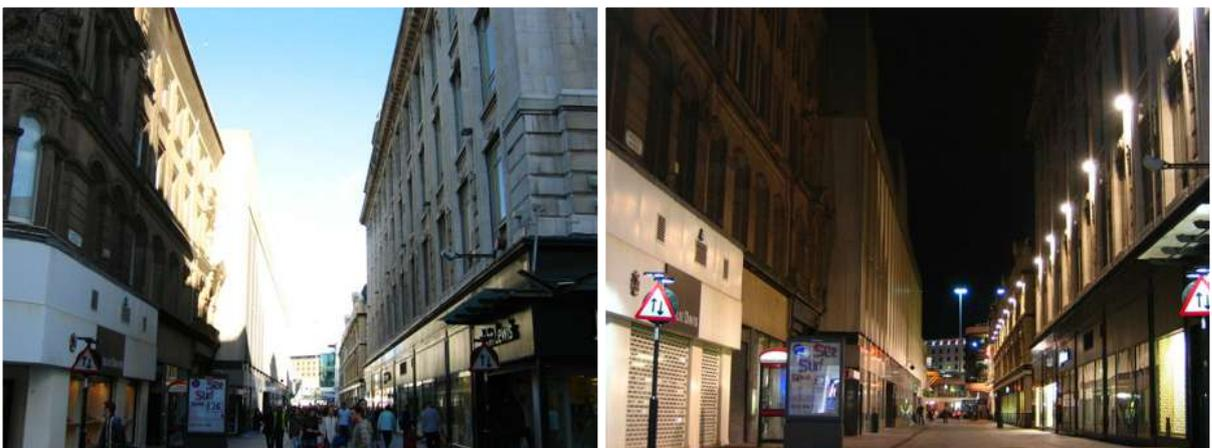
Basnett Street em Liverpool durante o dia e à noite, iluminada com projetores assimétricos fixados nos edifícios em apenas uma lateral. Esta solução contemplou o plano vertical e definiu a hierarquia entre os dois lados.
