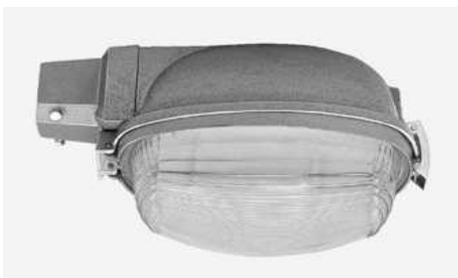
Luminária similar à utilizada para iluminação pública na maior parte do Triângulo, que são fixadas em cabos de aço atirantados aos edifícios. O refletor tem pouca eficácia devido ao seu baixo grau de polimento. Possui um visor em vidro prismado que garante um fecho muito aberto, projetando luz até um ângulo de aproximadamente 20° acima da horizontal. Isso aumenta a uniformidade da via e ilumina parte das fachadas dos prédios, mas também cria problemas de poluição luminosa.
