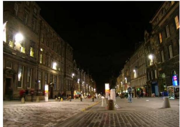
A Royal Mile, na cidade medieval, iluminada com fontes equipadas com lâmpadas multi-vapor metálico com temperatura de cor mais baixa (em torno de 3.000K). As luminárias estão instaladas nas fachadas dos edifícios em ambos os lados da via, inserindo os planos verticais no campo visual do observador.
