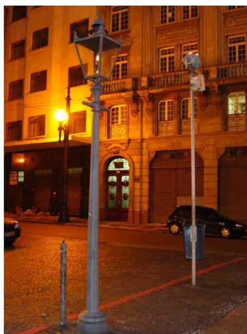
O poste que aloja o projetor que ilumina a fachada do edifício na esquina da rua Boa Vista. Percebe-se a inclinação do projetor para cima, que ocasiona desperdício de luz e poluição luminosa. Ao seu lado esquerdo encontra-se o poste a gás.
