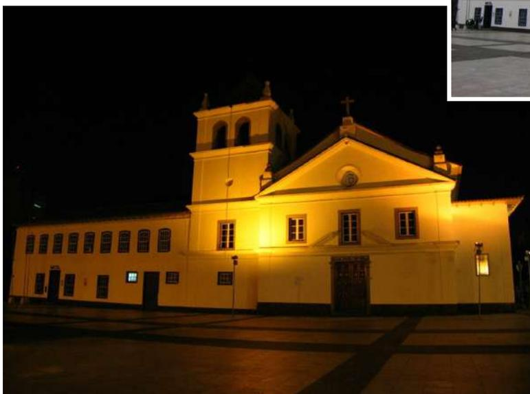
Sob a iluminação artificial o acabamento branco de sua fachada se torna laranja, devido à utilização de lâmpadas vapor de sódio. Somente a Basílica é iluminada e, mesmo assim, a solução não contempla seus detalhes de relevo. Repara-se o projetor do lado direito que está mal orientado, projetando a maior parte da luz para fora dos limites da arquitetura.
