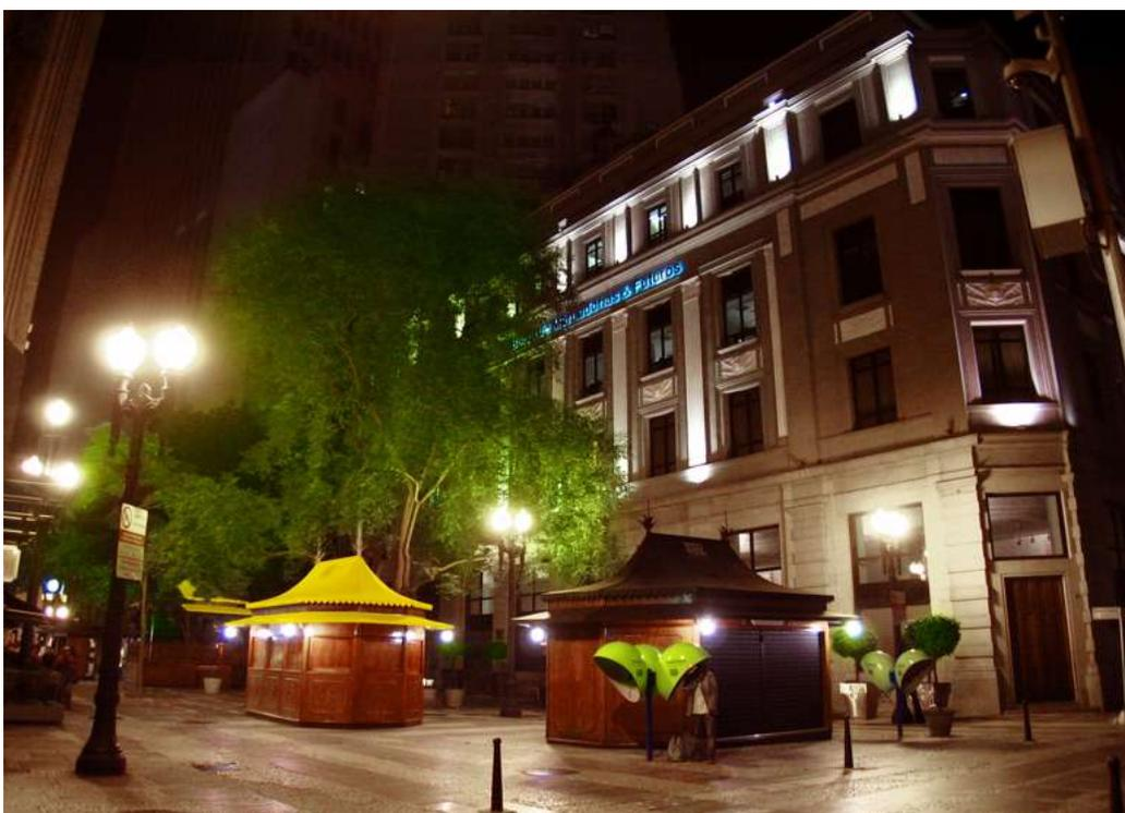
Conforme sugestão do Institution of Lighting Engineers (2005) a iluminância mais compatível com a tipologia de uso dos calçadões do Triângulo deve respeitar o índice de iluminância média, medida no plano horizontal, não inferior a 20lux e mínima não inferior a 8lux<sup>52</sup>. Com o objetivo de garantir bom reconhecimento de pessoas à distância, a relação da iluminância vertical (medida a 1,50m do piso) para a horizontal de 0,6:1 é adequada (BOYCE; BRUNO,1999 apud BULLOUGH 2003,
