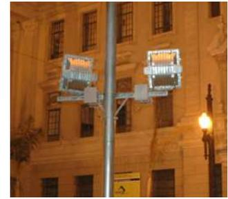
A fachada principal é iluminada principalmente por projetores fixados nos postes da via, localizados na calçada do Largo. A compreensão tridimensional é comprometida pela solução de luz frontal.
