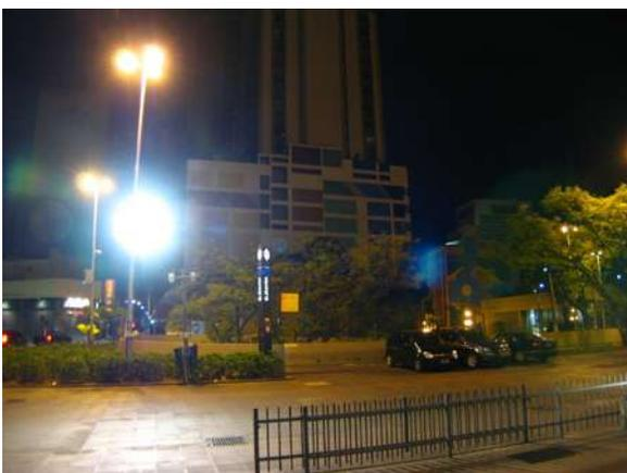
Visão da praça pelo observador na entrada da basílica. O ofuscamento causado por um dos projetores que iluminam sua fachada frontalmente compromete seriamente o conforto visual (brilho azulado).
