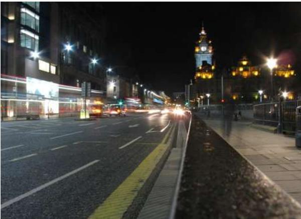
A Princess Street, na cidade nova, iluminada com fontes equipadas com lâmpadas multi-vapor metálico com temperatura de cor mais alta que as utilizadas nas vias da cidade medieval. As luminárias que iluminam a maior parte da via estão instaladas nas fachadas dos edifícios (à esquerda da foto).
