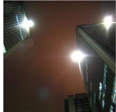
São dois projetores, equipados com lâmpadas multi-vapor metálico, fixados em cada lateral dos edifícios (alguns encontram-se apagados). Percebe-se que mesmo que suas intensidades sejam bem altas, o efeito mais marcante se trata do brilho interno dos ambientes, com intensidade bem menor, visualizado através das janelas.
