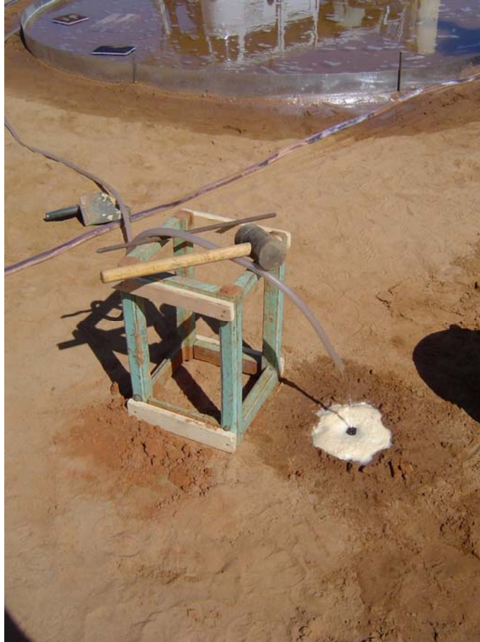
Figura 43 – Ensaio de infiltração em furo de sondagem a trado.
