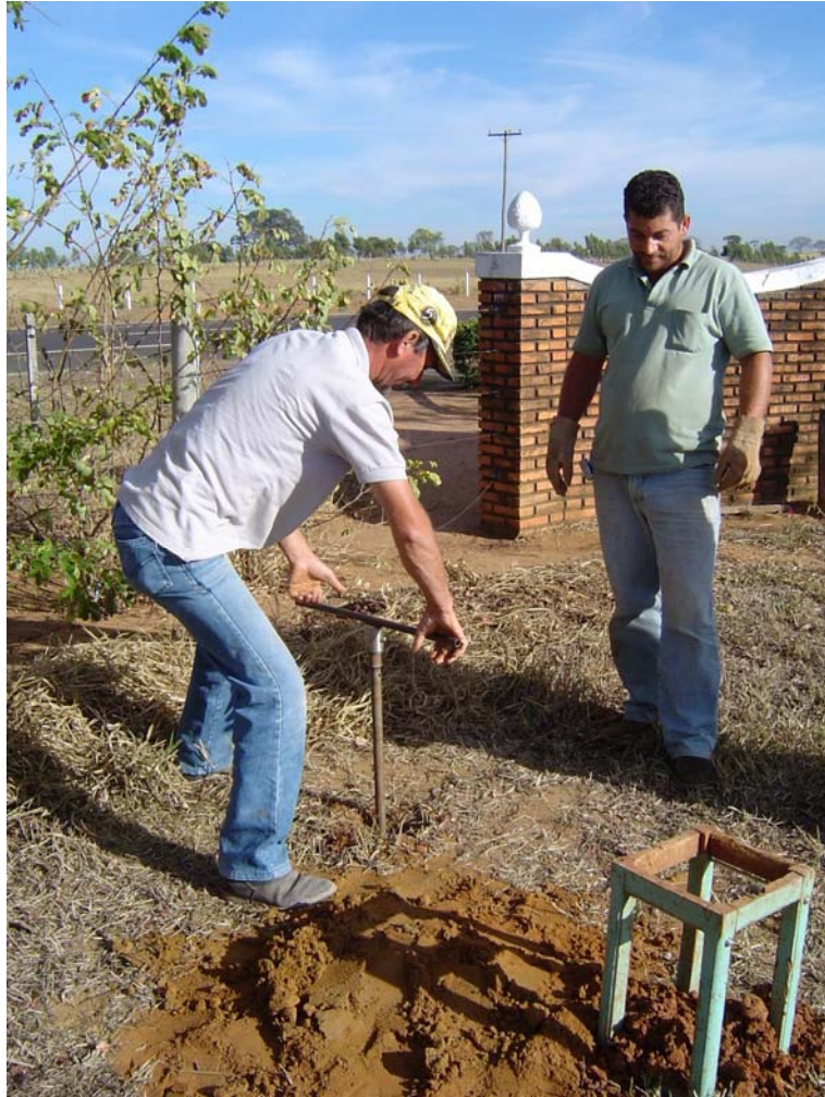
Figura 100 – Execução de tradagem para determinação de perfil de umidade.
