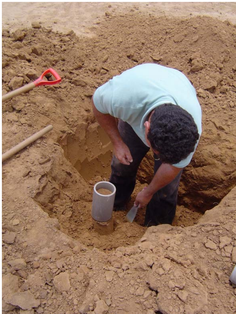
Figura 101 – Extração de amostra indeformada com auxílio de tubo de PVC de parede rígida.
