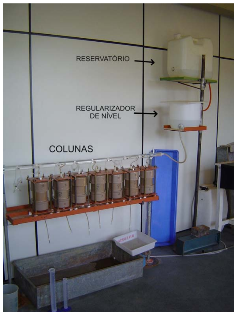
Figura 45 – Aparato de laboratório dos ensaios de coluna.
