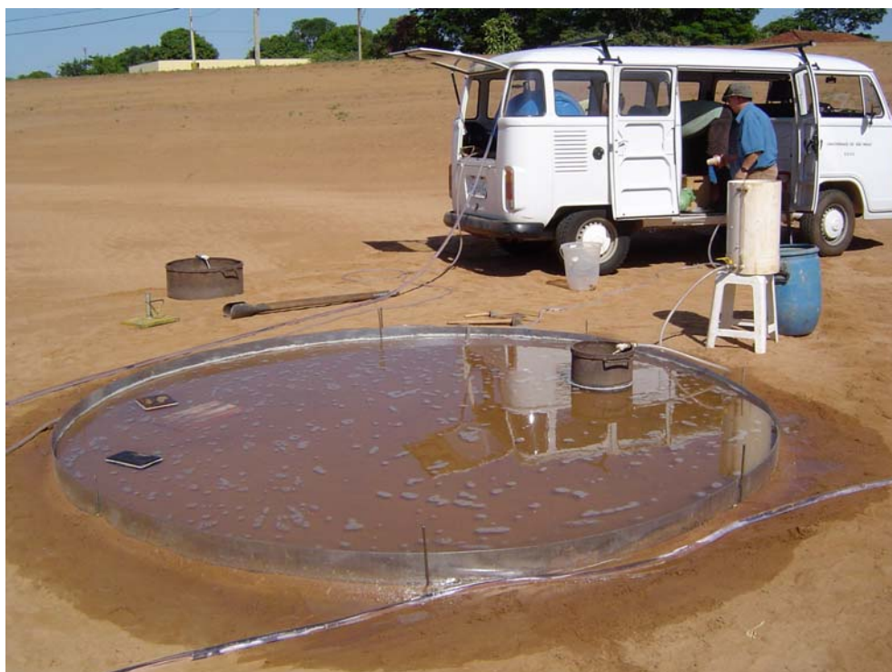
Figura 44 – Ensaio de infiltração de grandes dimensões – método do perfil instantâneo.
