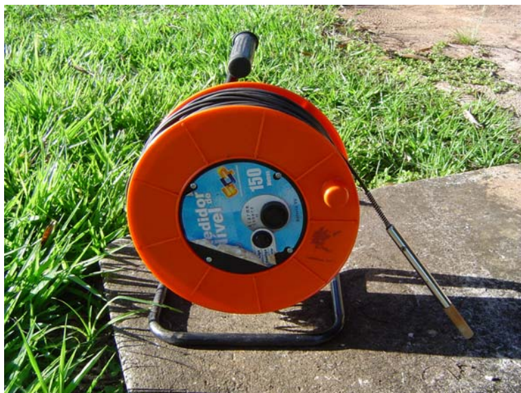
Figura 133 – Medidor de nível de água.
