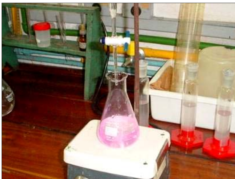
Foto 6. Determinação titulométrica do \text{Ba}(\text{OH})_2 residual.
