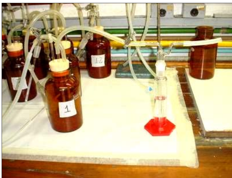
Foto 3. Microambiente de remediação nº 1 e frasco contendo solução de \text{BA}(\text{OH}_2) .
