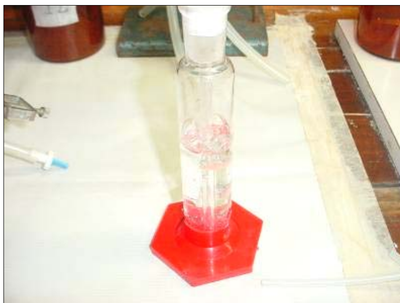
Foto 5. Frascos contendo solução de \text{Ba}(\text{OH})_2 sendo borbulhado por ar.
