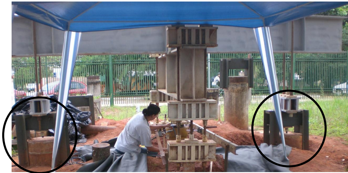
Figura 4.28 – Ligação dos tubulões com a viga de reação de 6 m
