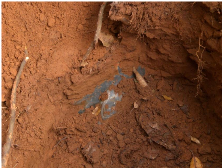
Figura 6.10 – Calda e solo fofo após extração do cilindro
