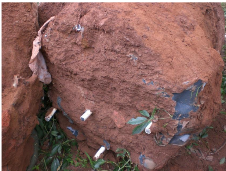
Figura 6.11 – Base do cilindro com injeção
