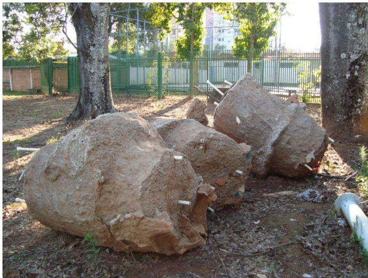
Figura 6.13 – Cilindros extraídos após lavagem com lavadora de alta pressão
