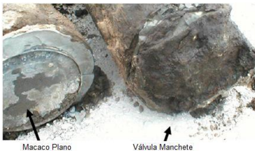
Figura 2.10 – Bases injetadas de estacas extraídas após cura da calda (Dapp et al. , 2006)
