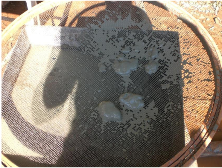
Figura 4.18 – “Grumos” de cimento
