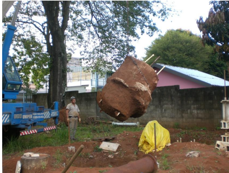
Figura 4.32 – Extração do cilindro com guindaste (b)
