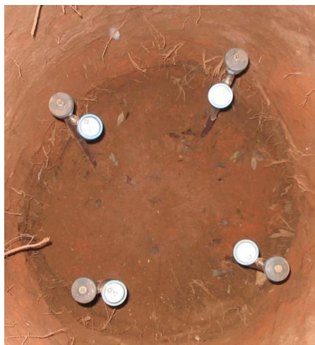
Figura 4.22 – Tensiômetros instalados na cava de controle.
