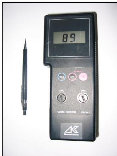
Figura 2.12 - Aparelho usado na medição do brilho “glossmeter”.
