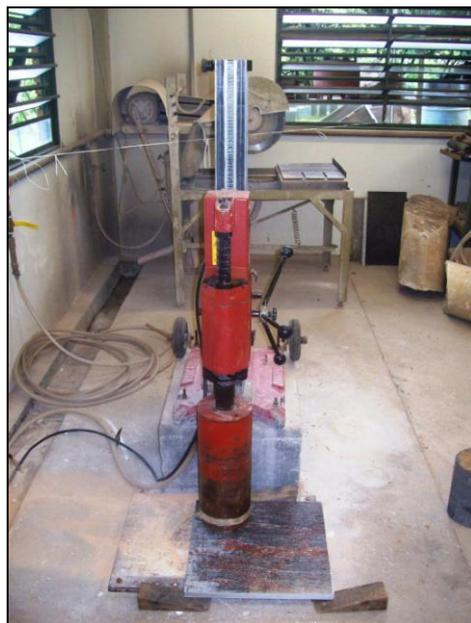
Figura 3.4 – Extração do corpo-de-prova com coroa diamantada de  $\text{Ø}15\text{cm}$ .
