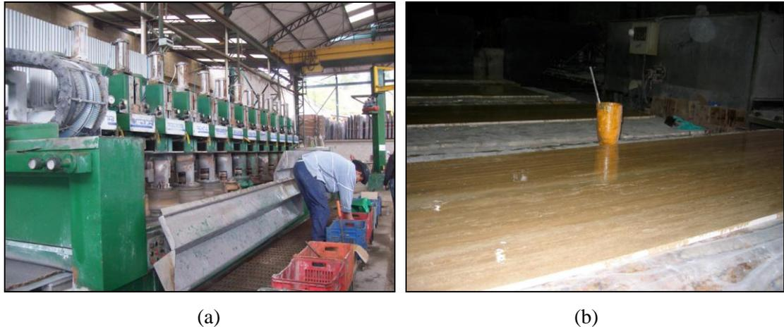
Figura 2.7 - (a) Polimento na superfície da placa de rocha e (b) adição de resina.
