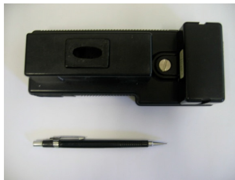
Figura 25. Glossmeter. Placa de metal encaixada no aparelho
