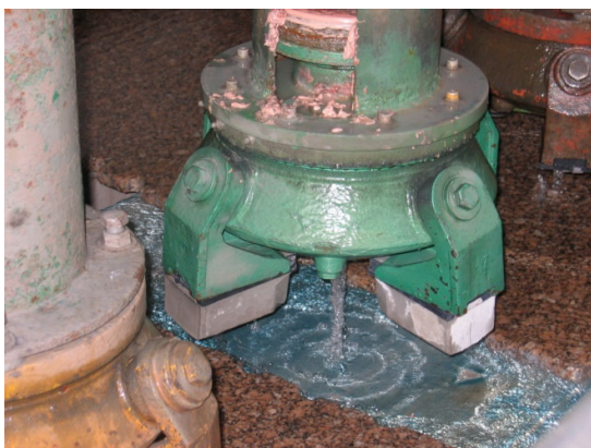
Figura 14- Cabeçote da politriz com água. Braminas (Bragança Paulista)
