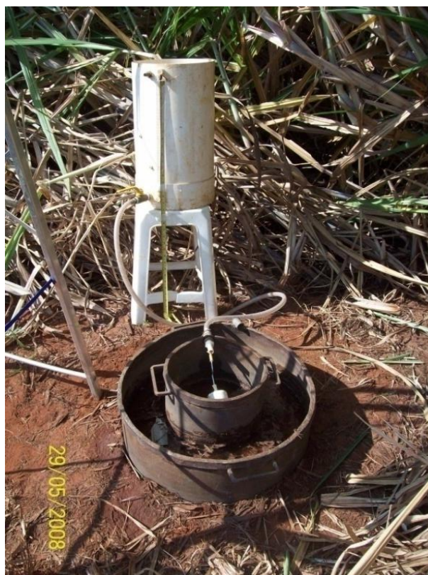
Figura 47 – Equipamento utilizado no ensaio de infiltração com duplo anel.
