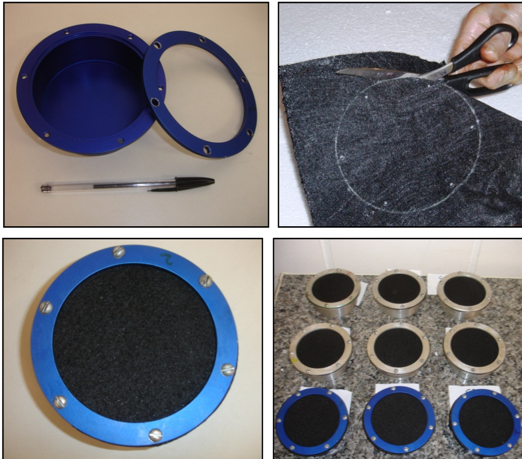
Figura 3.11 – Equipamento e montagem dos corpos de prova para o ensaio de transmissão de vapor d'água.
