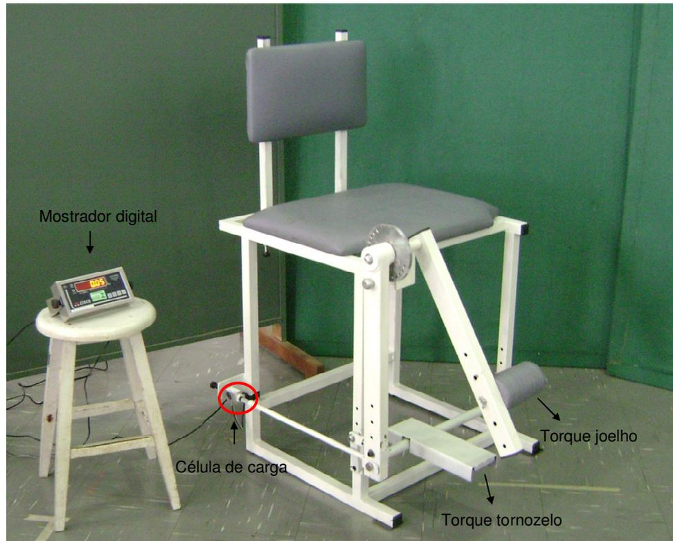
**Figura 5:** Sistema com mostrador e cadeira implementada com célula de carga para avaliação de torque articular
