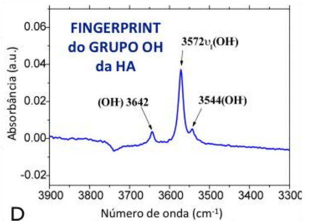
Figura 3: A- Gráfico representando a difração de raios X identificando a composição das fases na fina camada de HA depositada; B – Aparelho para a utilização da técnica de difração de raios-X de incidência rasante (GIXRD); C – Difração de raios-X com radiação de luz Síncrotron em incidência rasante; D - Gráfico representando as bandas vibracionais de HA, através da Microscopia de Reflectância Atenuada no Infravermelho por Transformada de Fourier (FTIRM-ATR)
