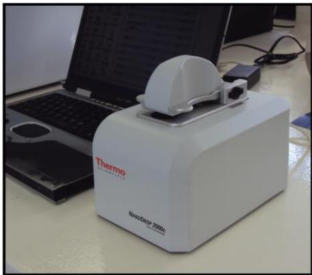
**Figura 5:** Espectrofotômetro (NanoDrop®2000c) utilizado para avaliar concentração e pureza do DNA extraído.
