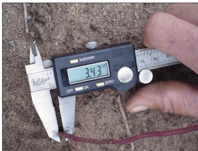
Figura 11: Medição do diâmetro de colo das mudas de eucalipto com paquímetro digital da marca Litz®.
