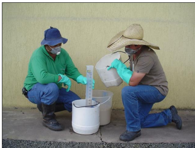
Figura 3. Determinação do volume de calda absorvido.
