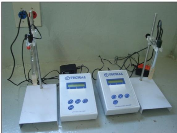
Figura 7: Peagômetro e Condutivímetro.
