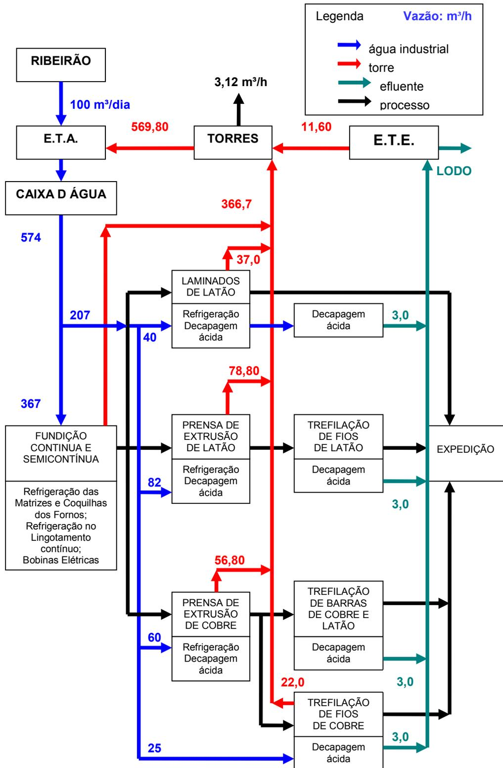
Figura 5: Diagrama do fluxo de processo e balanço hídrico de metalurgia
