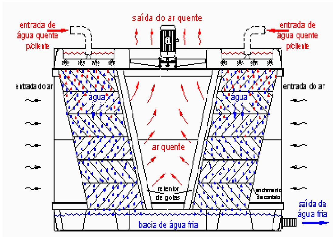
Figura 2: Princípio de operação de torre de resfriamento
