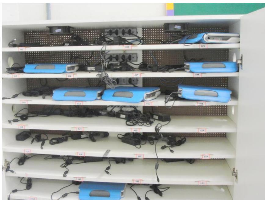
Figura 15: Armário adaptado para o recarregamento de baterias.
