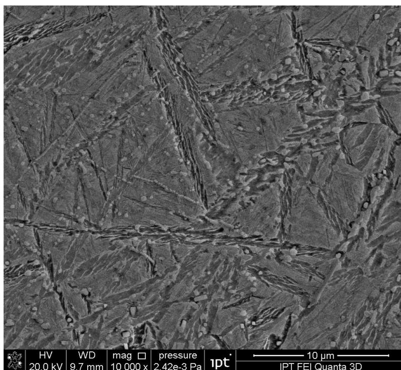
**FIGURA 4.6** - Microestrutura da amostra resfriada no forno (RF). Matriz com presença de bainita e carbonetos secundários. MEV – elétrons secundários.
