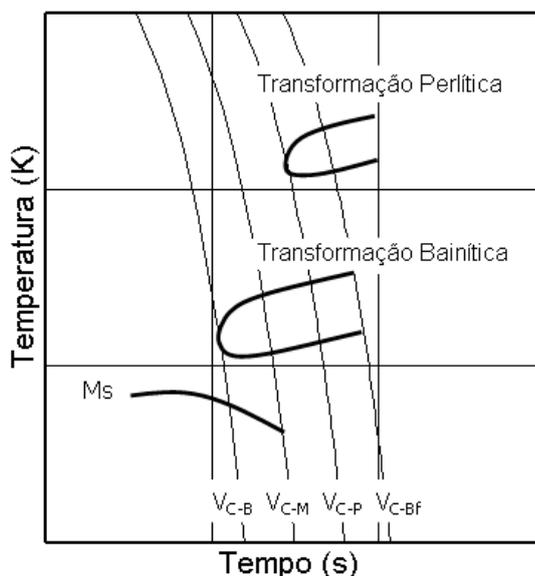
**FIGURA 2.13** – Determinação das taxas críticas de resfriamento para a curva CCT da liga Fe-5%Cr-5%Mo-5%W-5%V-5%Co-2%C (YOKOMIZO; MATSUBARA e SASAGURI, 1999).
