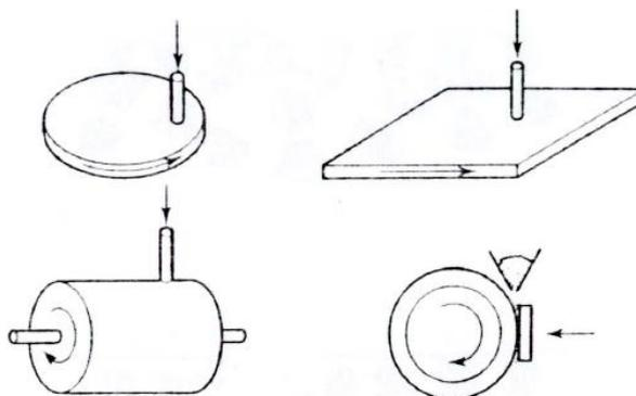
**FIGURA 2.24** – Configurações empregadas em ensaios de desgaste abrasivo (HUTCHINGS, 1992).
