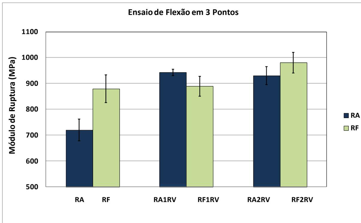
**FIGURA 4.9** – Resultados dos ensaios de flexão em três pontos nas amostras sob diferentes condições de tratamentos térmicos.
