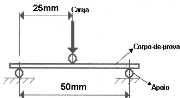
**FIGURA 3.10** – Representação esquemática do ensaio de flexão.
