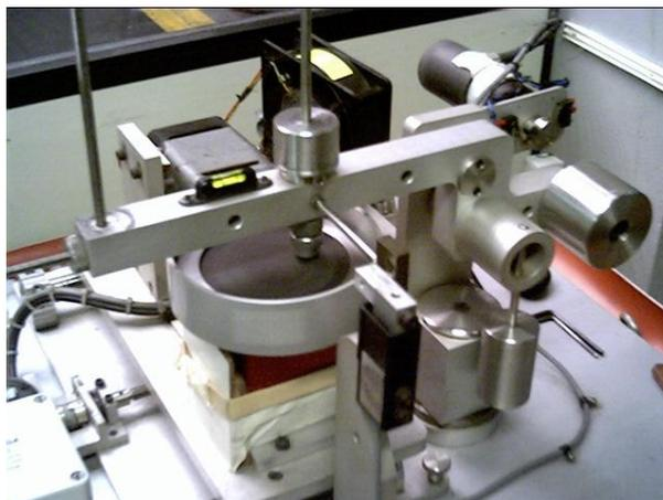
**FIGURA 3.12** - Tribômetro para realização do ensaio pino-contra-disco.
