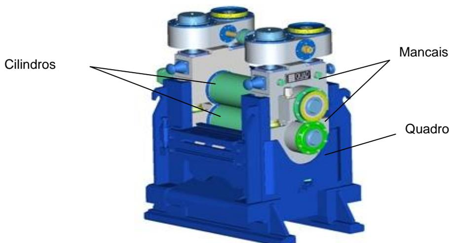
**FIGURA 2.1** – Esquema de um laminador duo<sup>2</sup>
