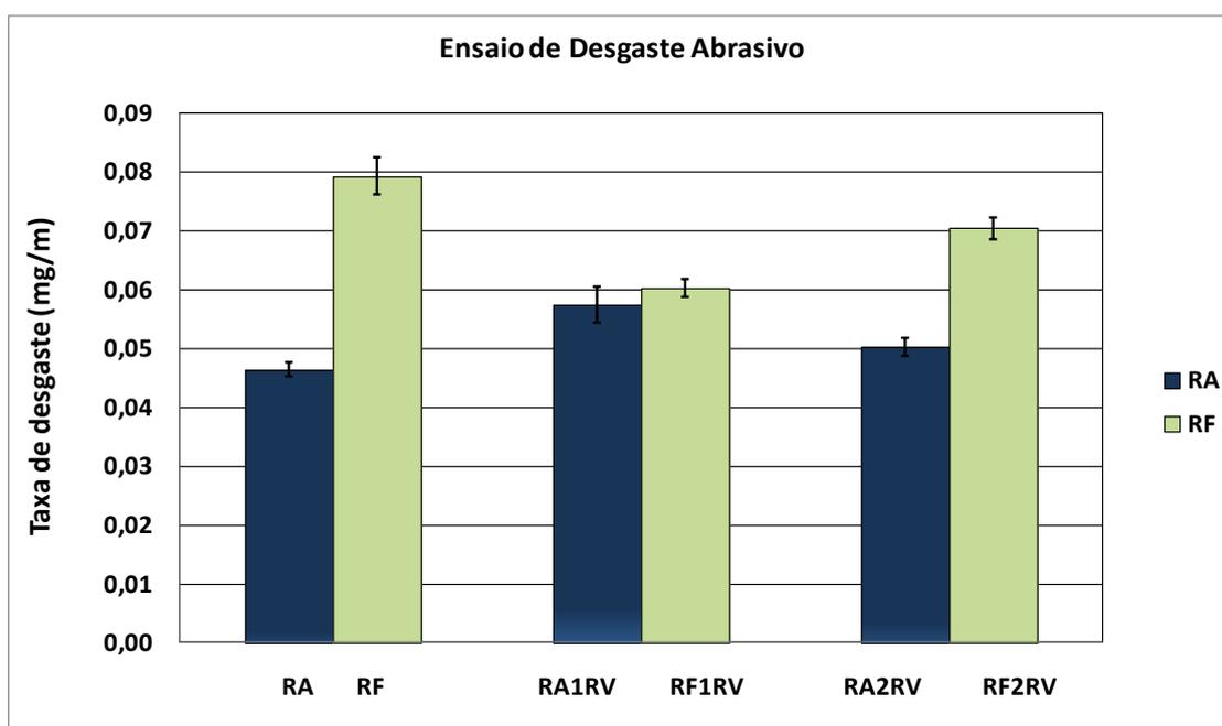
**FIGURA 4.14** - Taxas de desgaste obtidas no ensaio pino-contra-disco.
