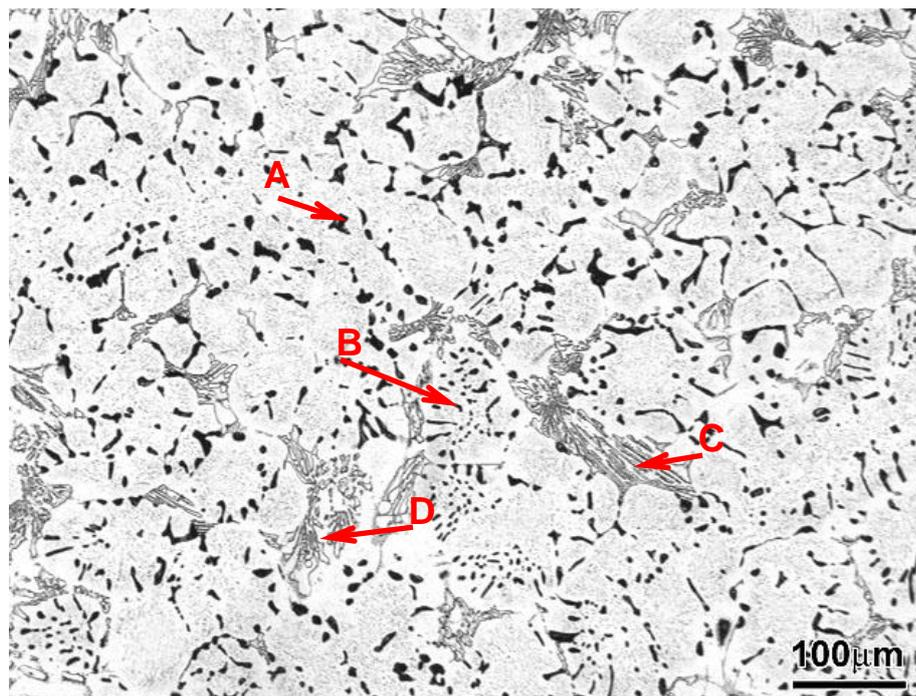
**FIGURA 4.1** – Micrografia do anel resfriado no forno com um revenimento (RF1RV) na região mais externa. Ataque: eletrolítico + groesbeck. A: carboneto eutético MC irregular. B: carboneto eutético MC regular complexo. C: carboneto  $M_2C$ . D: carboneto indefinido.
