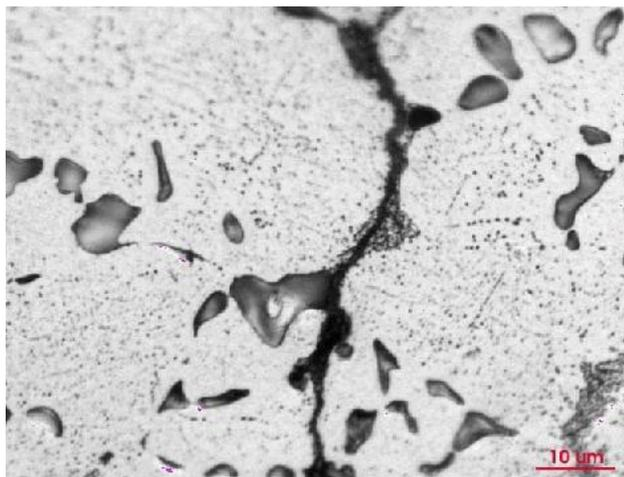
**FIGURA 2.10** - Seção transversal do corpo-de-prova de um ferro fundido branco multicomponente após ensaio de fadiga térmica (SERANTONI, 2003), mostrando o caminho de propagação de trinca pela interface carboneto / matriz. Ataque: Eletrolítico + Groesbeck.
