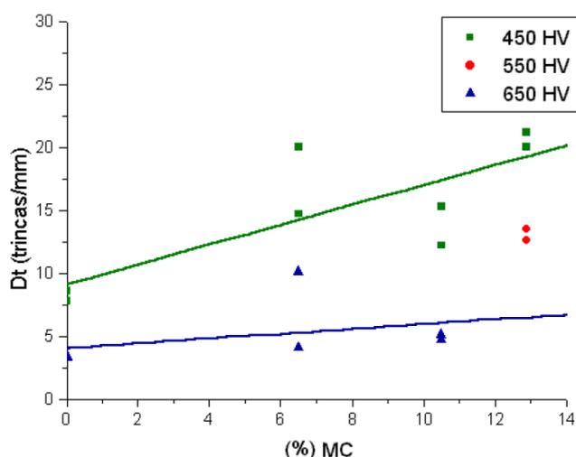
**FIGURA 2.9** - Densidade de trincas em função da fração volumétrica de carboneto eutético MC e do nível de dureza da matriz para o ensaio de fadiga térmica de 100 ciclos (SERANTONI, 2003).
