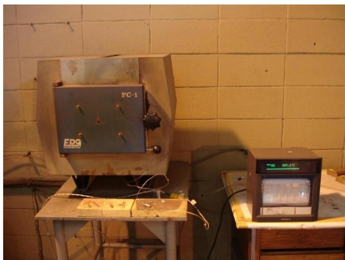
**FIGURA 3.4** - Arranjo experimental utilizado durante os tratamentos térmicos.
