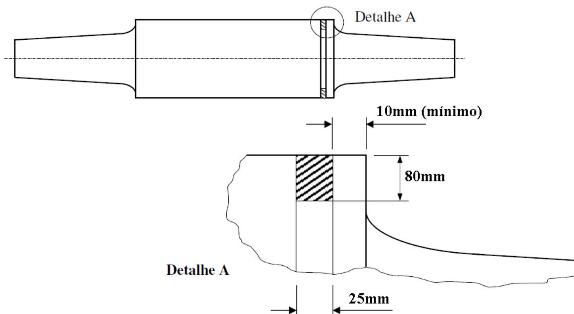
**FIGURA 3.1** - Local da retirada do anel no cilindro.
