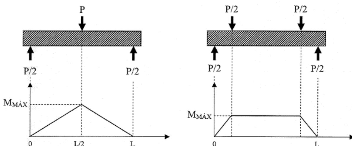
**FIGURA 2.21** – Esquema dos ensaios de flexão em 3 pontos (esquerda) e quatro pontos (direita) e das respectivas distribuições do momento fletor. Adaptado de Meyers e Chawla (2009).
