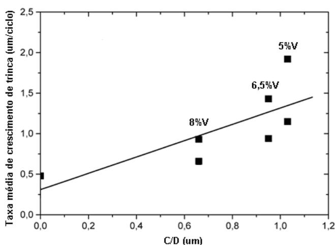
**FIGURA 2.11** – Correlação entre propagação de trinca e a relação C/D para três ferros fundidos brancos multicomponentes com diferentes teores vanádio. Ensaio de fadiga térmica em 100 ciclos. (SERANTONI; BOCCALINI, 2005).
