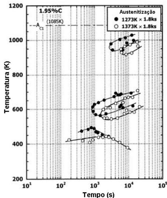
**FIGURA 2.12** - Curva CCT de um ferro fundido branco multicomponente (Fe-5%Cr-5%Mo-5%W-5%V-5%Co-2%C) (YOKOMIZO; MATSUBARA; SASAGURI, 1999).
