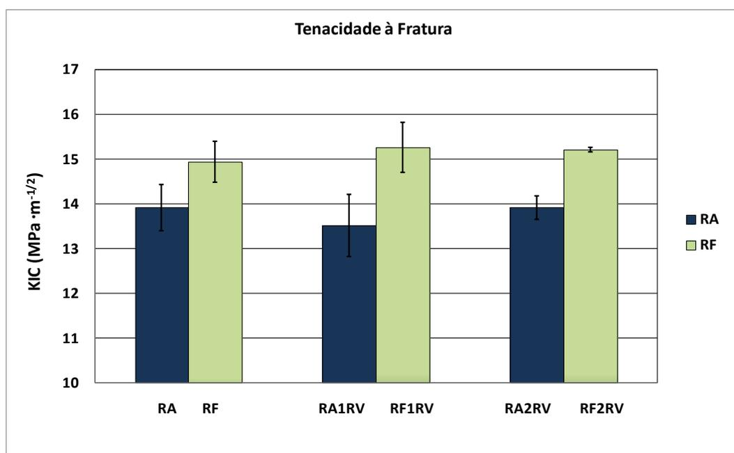
**FIGURA 4.11** – Resultados de tenacidade à fratura obtidos pelo ensaio utilizando a metodologia *Chevron*.
