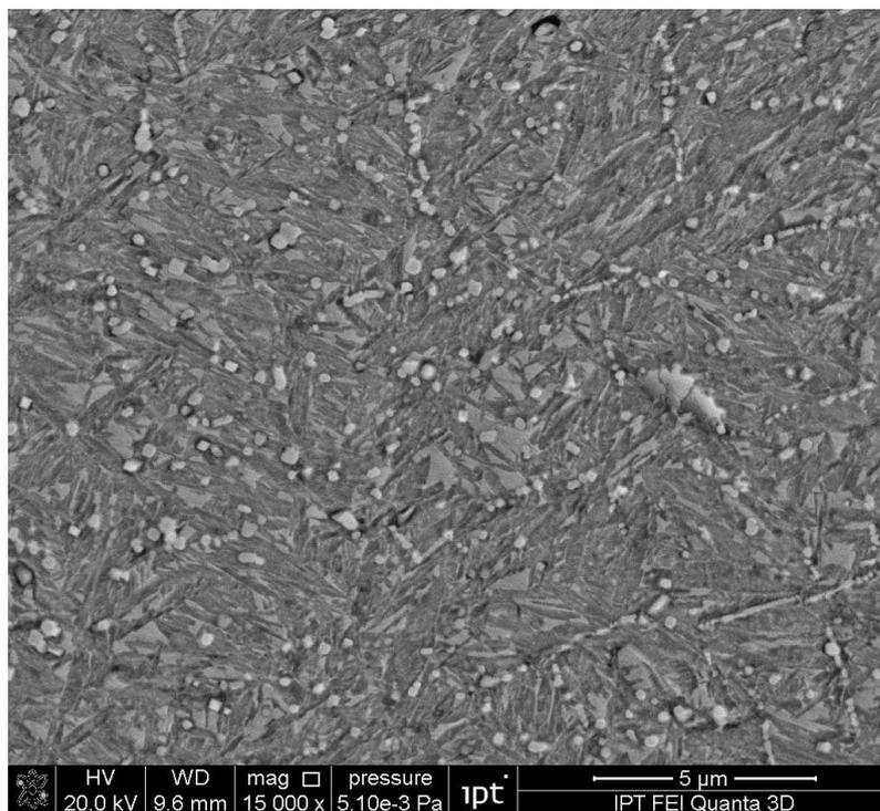
**FIGURA 4.5** – Microestrutura da amostra resfriada ao ar (RA). Matriz martensítica e carbonetos secundários. MEV – elétrons secundários.
