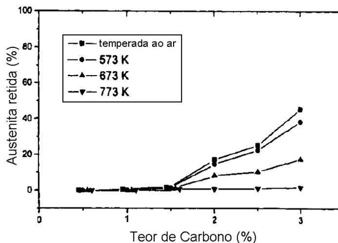
**FIGURA 2.15** – Relação entre o teor de carbono e a austenita retida nas amostras austenitizadas a 1273K, temperadas ao ar e revenidas em diferentes temperaturas (YU, 1997).
