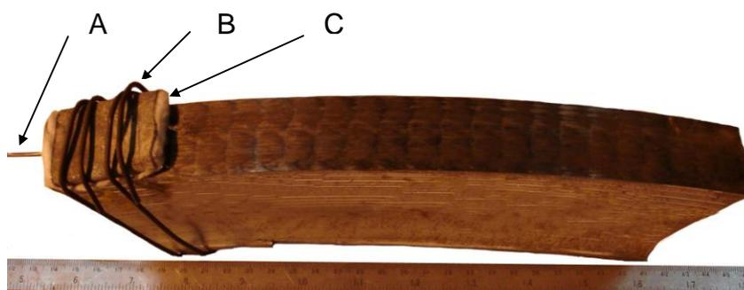
**FIGURA 3.5** – Montagem do conjunto termopar (A), chapa metálica (B) e manta refratária (C) para realização do tratamento térmico.
