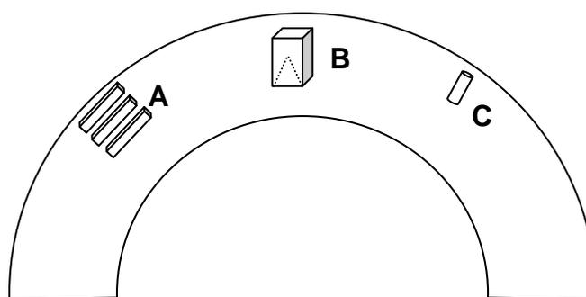
**FIGURA 3.8** – Esquema representando a orientação dos corpos-de-prova retirados do anel para os ensaios de flexão (A), *Chevron* (B) e desgaste abrasivo(C).
