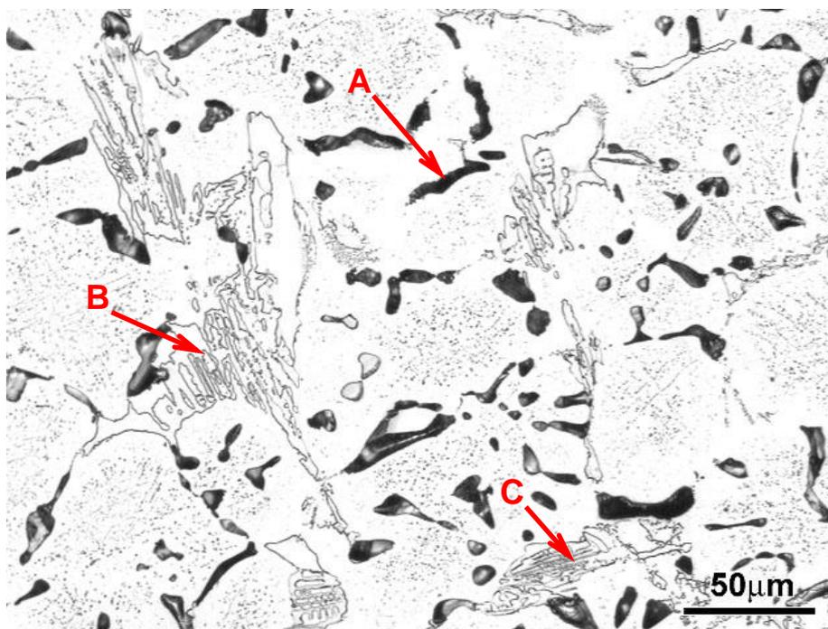
**FIGURA 4.2** – Micrografia do anel resfriado no forno com um revenimento (RF1RV) na região mais interna. Ataque: eletrolítico + groesbeck. A: carboneto eutético MC irregular. B: carboneto indefinido. C: carboneto  $M_2C$ .
