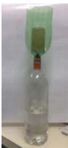
Figura 4.13:- Realização da filtragem com filtro simples (vela).
