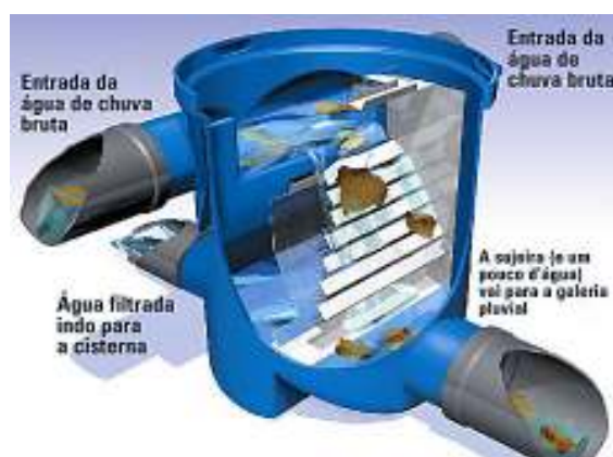
Figura 3.19: Filtro para água de chuva bruta.
