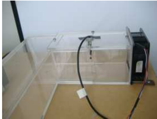
Figura 4.4: Entrada do sistema, onde estão instalados o ventilador e sensor de temperatura.
