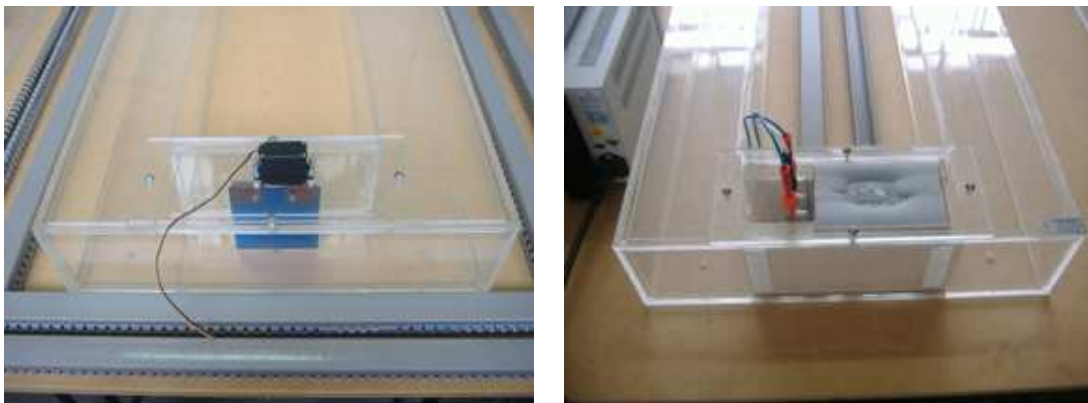
(a) Damper para controle da vazão volumétrica de ar. (b) Detalhe da Seção 5. Isolamento térmico do atuador de aquecimento.
