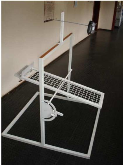
Figura 5.1: Dispositivo construído para a obtenção das imagens que representam as características de nado dos peixes.
