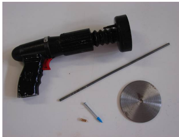
Figura 2-12 Equipamento utilizado no ensaio de penetração de pino
