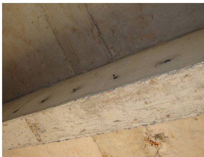
Figura 3-7 Estudo piloto de potência para a obra B ( f_{cj} = 34,7 MPa) – Potência alta
