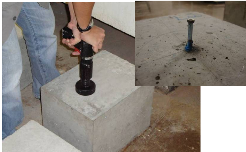
Figura 2-11 Execução do ensaio de penetração de pino
