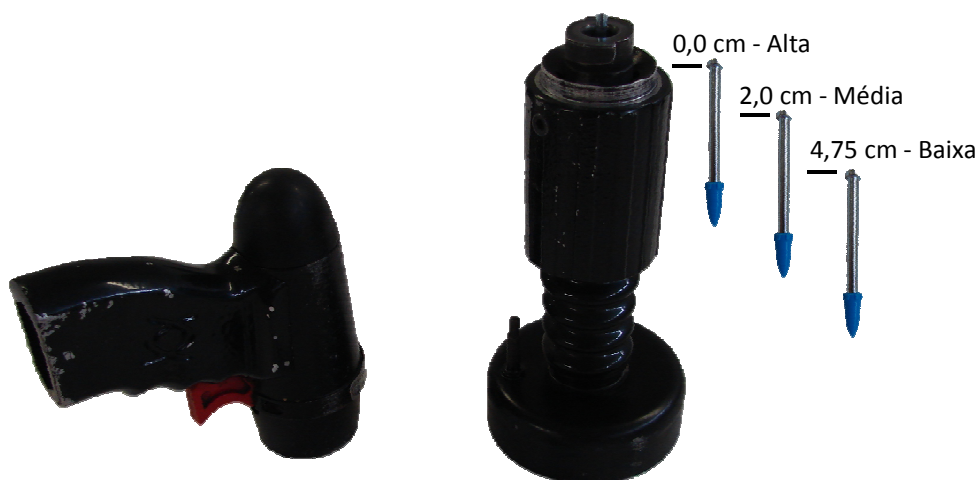
Figura A. 4 Posição do pino para as potências utilizadas
