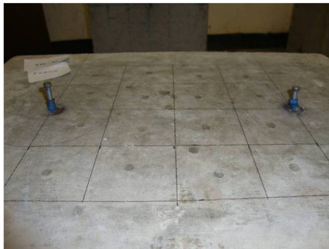
Figura 3-22 – Ensaio de penetração de pino e esclerometria
