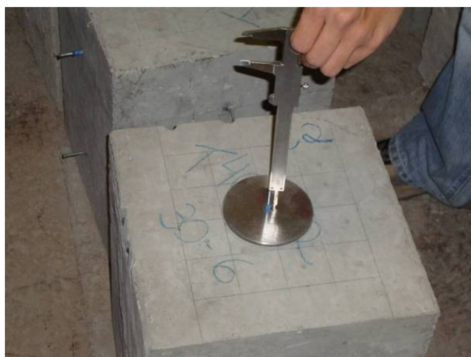
Figura 3-24 – Medição do comprimento exposto do pino
