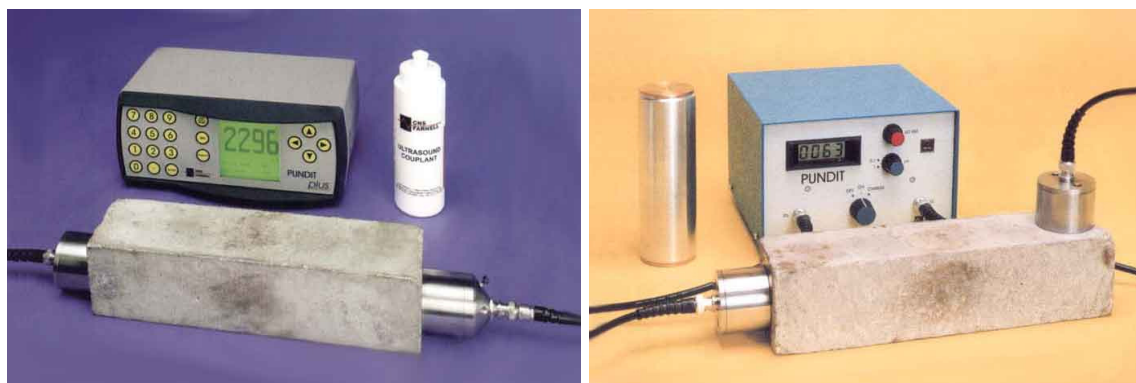
Figura 2-7 Ensaio da velocidade de propagação da onda ultrassônica ( http://www.cmhtest.co.uk/products/pundit.html )
