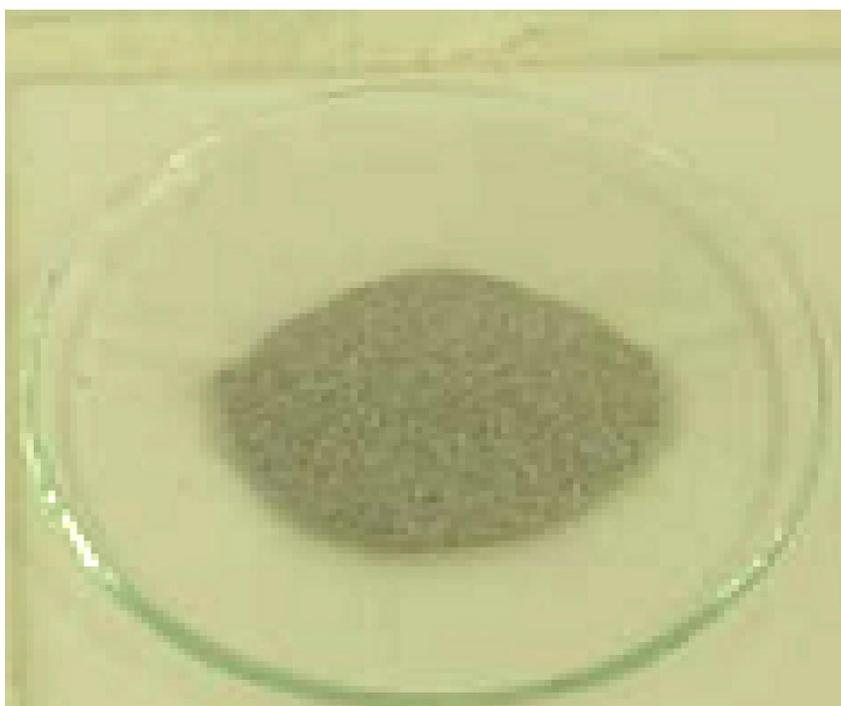
Figura 7 - Fotografia da amostra de catalisador exaurido.
