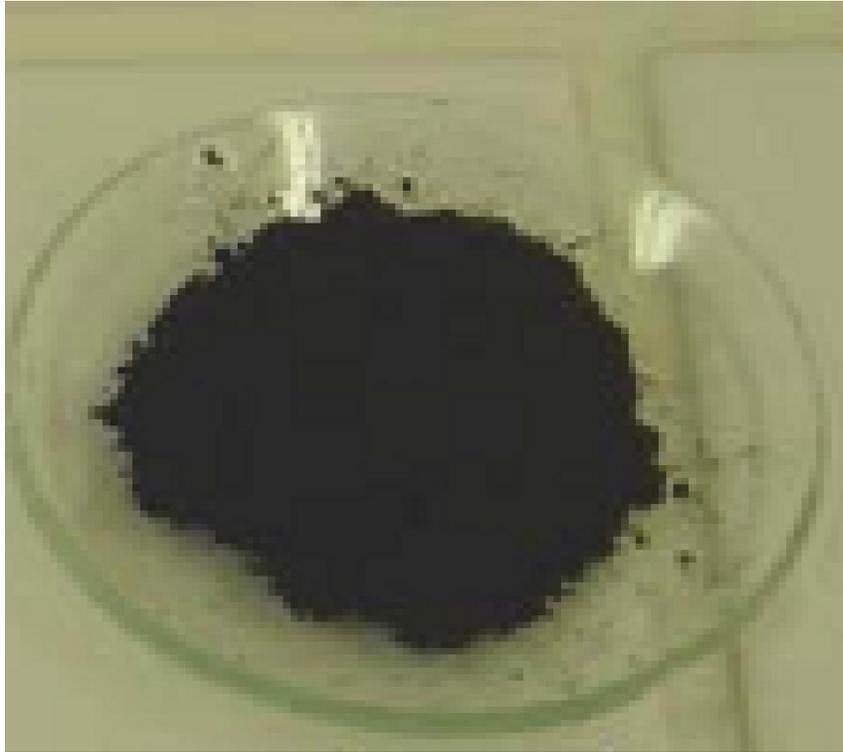
Figura 13 - Fotografia da amostra de Carvão ativado (CAP-117).
