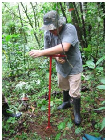
FIGURA 3 - A) COLETA COM ESPÁTULA NA PROFUNDIDADE 0-5 CM; B E C) COLETA COM TRADO HOLANDÊS A PARTIR DA PROFUNDIDADE 5 CM.
