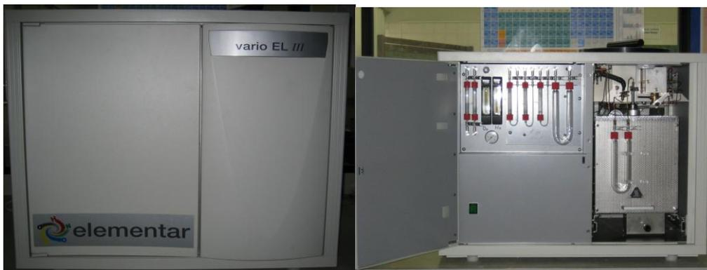
FIGURA 6 - VISTA EXTERIOR E INTERIOR DO ANALISADOR ELEMENTAR CNHS MODELO VARIO EL.
