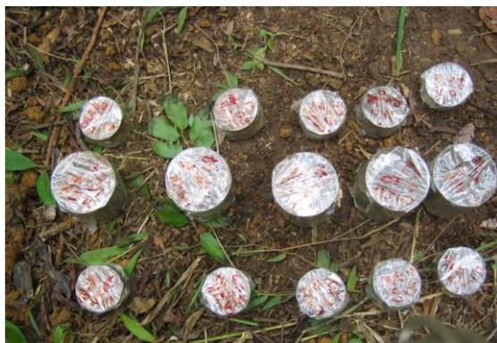
FIGURA 5 – ACONDICIONAMENTO DOS ANÉIS DE KOPECKY COLETADOS PARA AMOSTRAS INDEFORMADAS.
