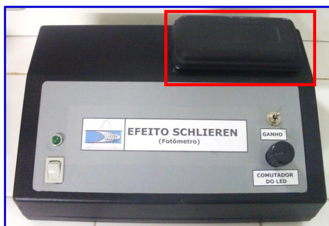
FIGURA 2.4. Fotografia do fotômetro desenvolvido. O destaque (em vermelho) mostra a câmara que abriga a cela de fluxo.
