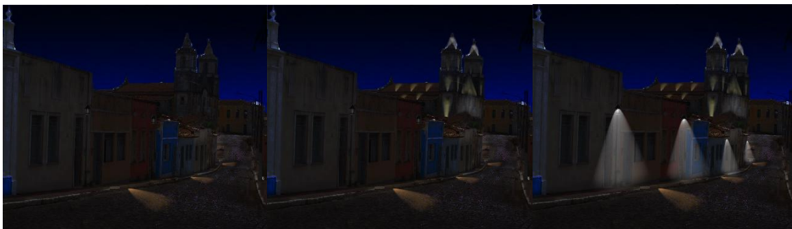
Figura 147 – Sistema de iluminação para a Rua Tobias Barreto, composto por arandelas instaladas nas fachadas das casas, sistema de balizamento para procissões e iluminação da igreja matriz ao fundo. Fonte: Arquivo pessoal do autor.
