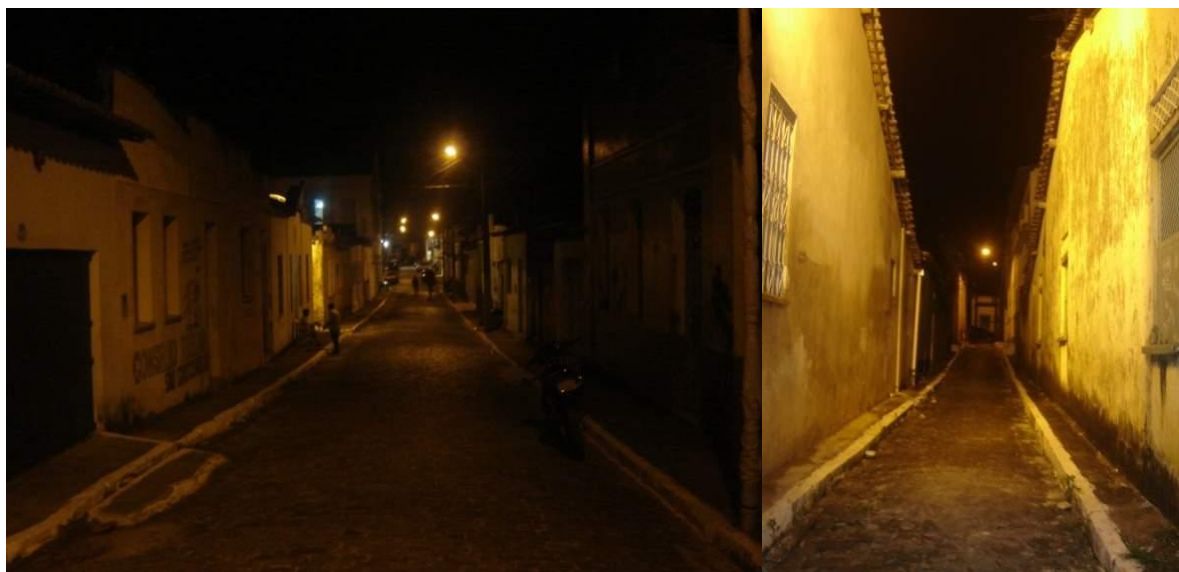
Figura 69 - Grande contraste entre zonas claras e escuras, causado pelo grande espaçamento entre postes (esquerda) e viela excessivamente iluminada por uso de projetores (direita). Fonte: MOISINHO, 2009.
