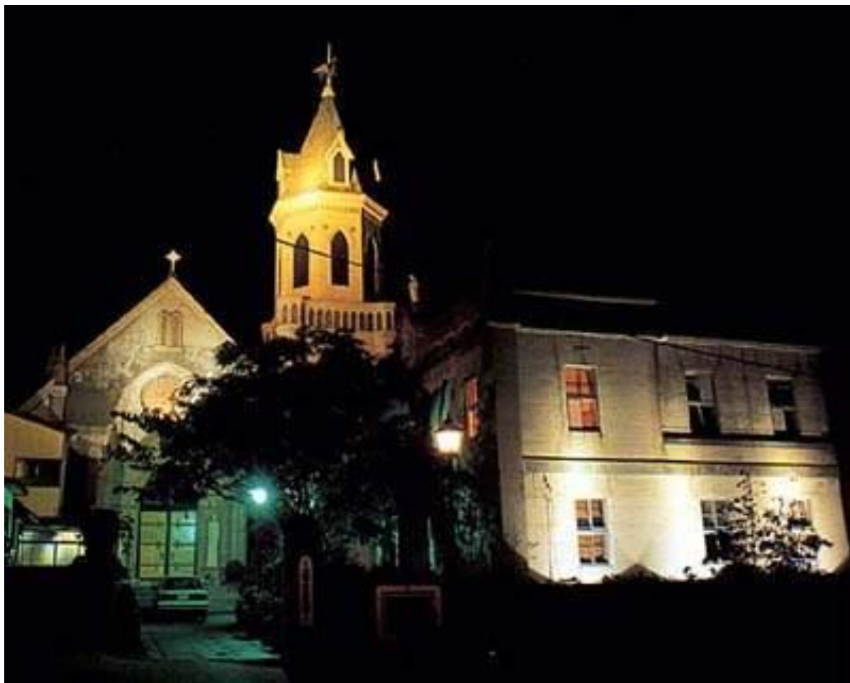
Figura 87: Fachada iluminada com lâmpadas de vapor de sódio, de aparência amarelada, e Vapor metálico, mais esbranquiçado.
