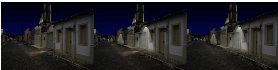
Figura 148 – Sistema de Iluminação para a Rua Messias Prado. Tendo a Igreja Nossa Senhora do Amparo dos Homens Pardos em um dos lados. Sistema composto por arandelas, balizadores e iluminação de fachadas.
