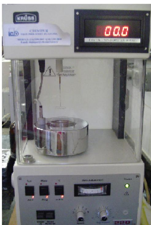
Figura 10. Tensiômetro digital Krüss K10
