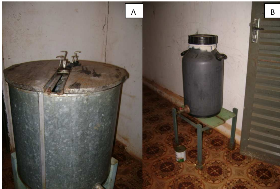
Figura 7. Condições dos equipamentos utilizados: centrífuga (A) e tanque de decantação (B) em uma das Unidades de Extração.
