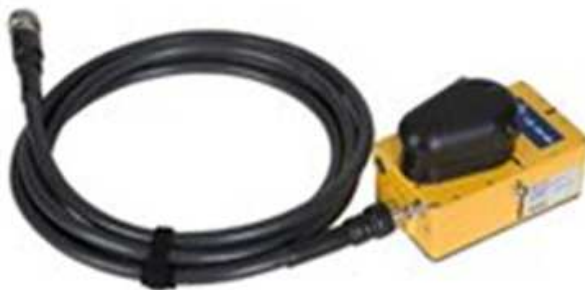
Figura 43. Antena Shielded HF da MALA com frequência central de 1,6 GHz.
