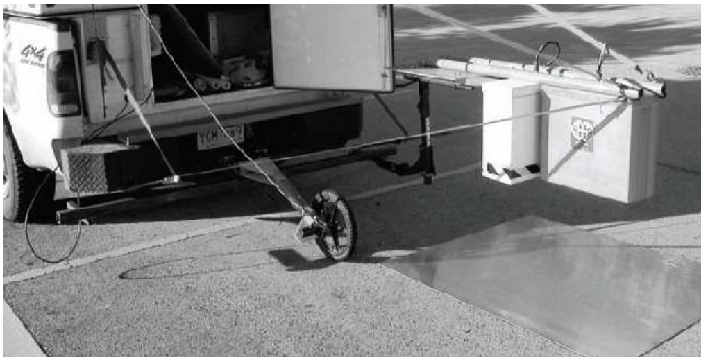
Figura 7. Aspecto de uma “Air-coupled antenna” dispostas em duas polaridades, sendo calibrada com uma placa de metal (SAARENKETO, 2006).
