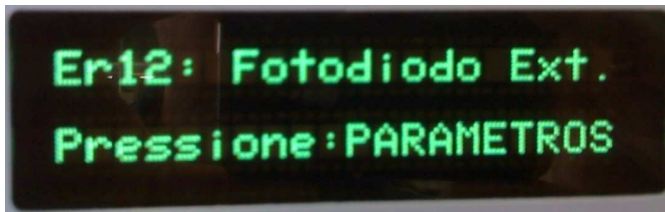
Figura 4-26 – Imagem da informação exibida no display de ocorrência de variação de emissão superior a 20%.
