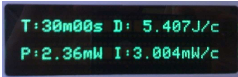
Figura 4-24 Imagem da informação exibida no display de tempo, potência, irradiância e dose, estando o spot de 10mm de diâmetro selecionado.
