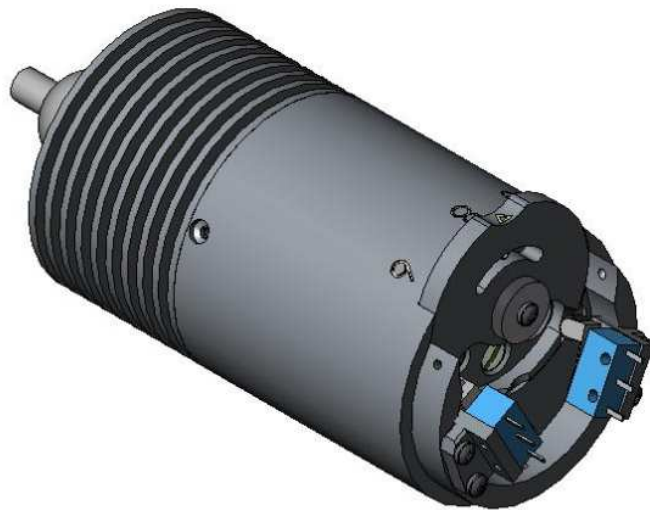
Figura 3-9 – Esboço da roda de spots acoplada com as chaves de identificação do estado selecionado (representadas em azul).
