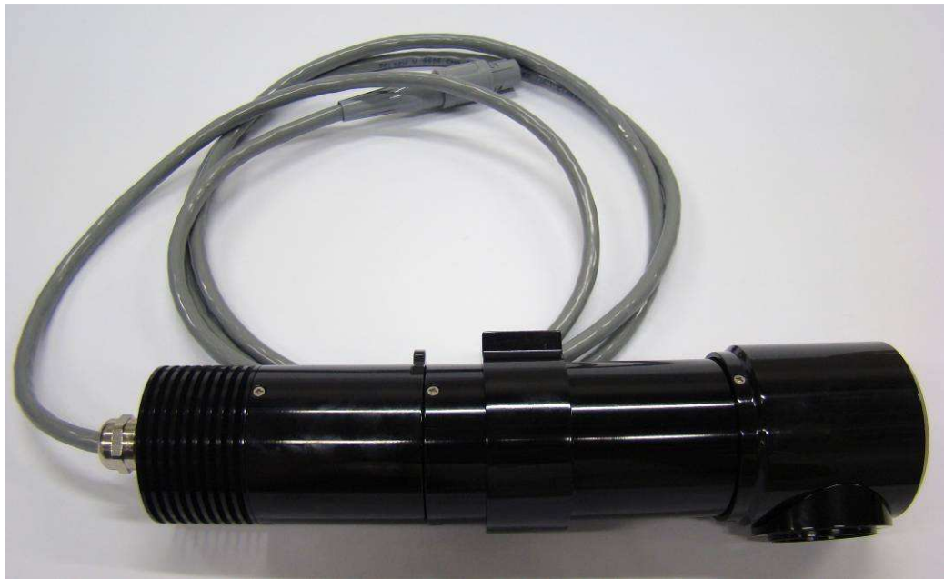
Figura 4-1 – Foto do sistema de iluminação ultravioleta confeccionado a partir do projeto mecânico.
