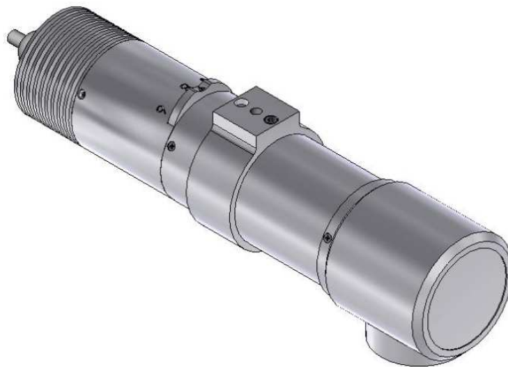
Figura 3-7 – Esboço em três dimensões do suporte para irradiações ultravioletas (SIU).
