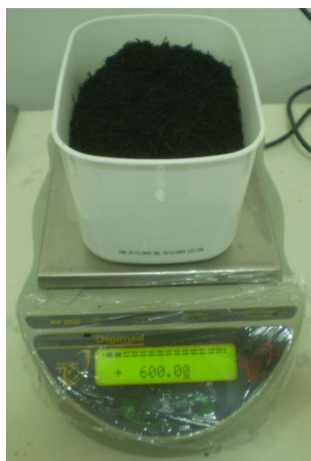
Figura 3.4 – Amostra com 600 gramas de resíduo
