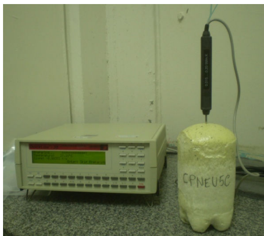
Figura 3.12 – Analisador de propriedades térmicas Quickline™-30 e Corpo de Prova em análise
