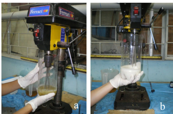
Figura 3.10 – (a) Agitação do poliol no misturador mecânico (b) Mistura no tempo de creme
