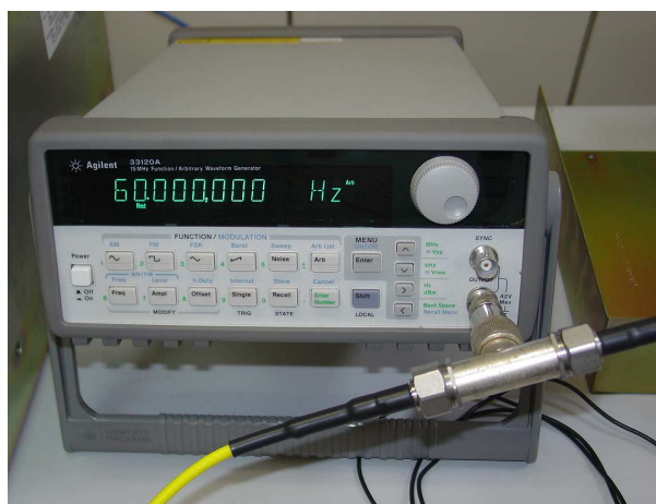
Figura 267: Adaptador utilizado para enviar o sinal do gerador de funções a dois equipamentos diferentes.
