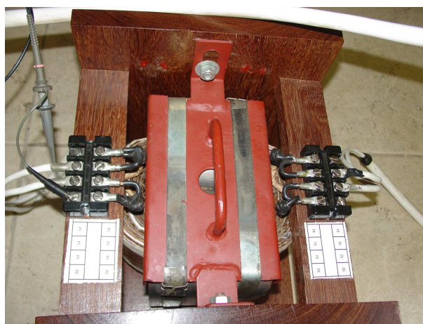
Figura 270: Conexões para o transformador isolador.
