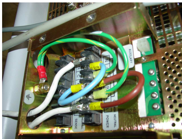
Figura 269: Conexões para os terminais de saída da fonte de potência.
