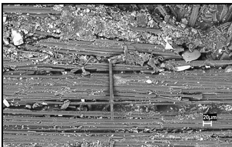
Figura 75 – Análise por MEV da superfície externa do compósito unidirecional condicionado em câmara de ozônio e ensaiado em cisalhamento interlaminar à temperatura ambiente (22°C).
