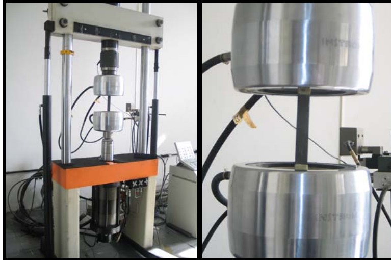
Figura 18 - Máquina universal de ensaios Instron mod. 1332 utilizada.
