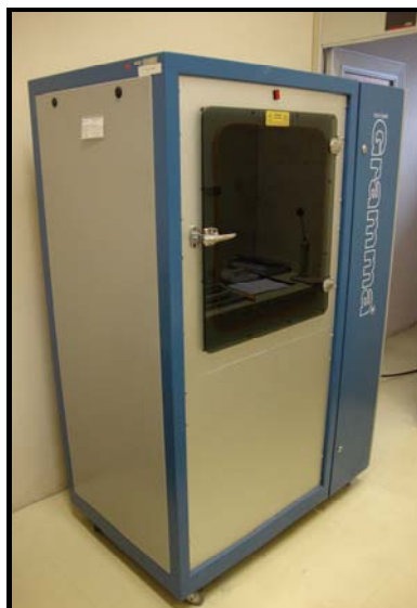
Figura 16 - Câmara de ozônio utilizada, marca Gramma.
