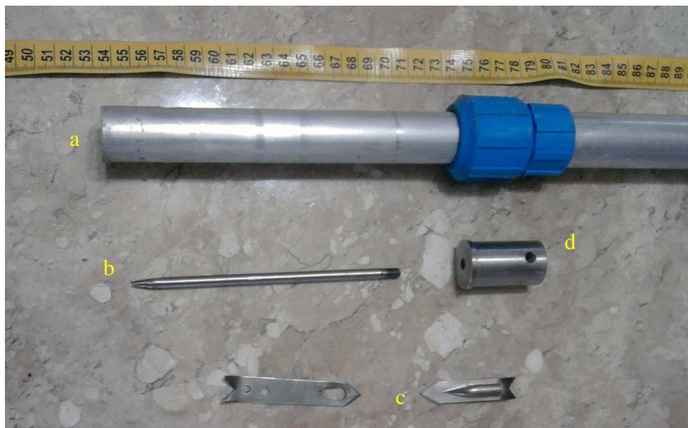
Figura 9- (a) Lança ( pole ) telescópico, (b) aplicador, (c) ponteiros e (d) adaptador do aplicador utilizado para marcar o tubarão-baleia. Foto: Bruno Macena.
