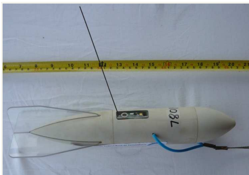
Figura 10- Transmissor SPLASH utilizado para marcação do tubarão-baleia no ASPSP. Foto: Bruno Macena.
