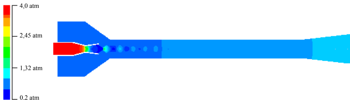
FIGURA 5.1. Distribuição da pressão estática no ejetor
