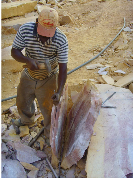
Figura 16: Trabalho de desplacamento do quartzito.
