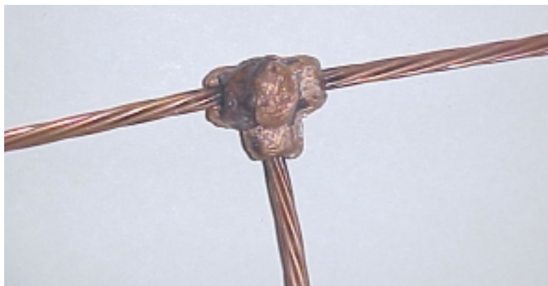
Figura 5.5 – Detalhes da conexão da solda.
