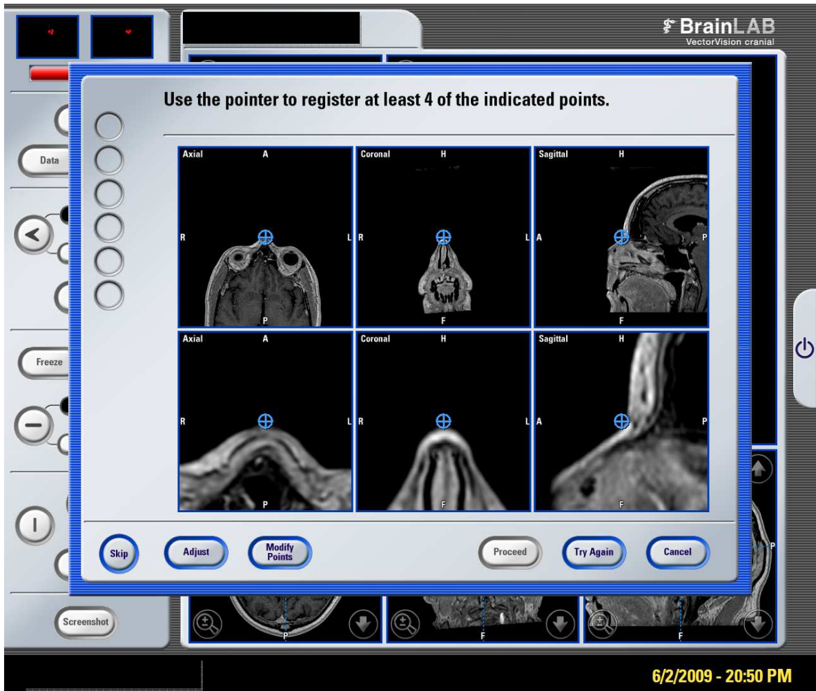
Figura 40 - Imagem do neuronavegador mostrando o primeiro ponto a ser marcado, o nariz, tocando a região da face do paciente com o apontador pré-calibrado, sem pressão, de modo que as câmeras do navegador visualizassem o instrumento
