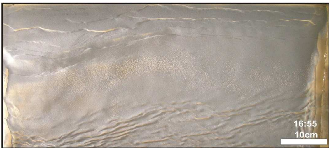
Figura 78: Conjunto de fotografias da superfície do experimento 2902, mostrando a propagação das dobras escalonadas ( en-échelon ), subparalelas à falha de base do silicone.
