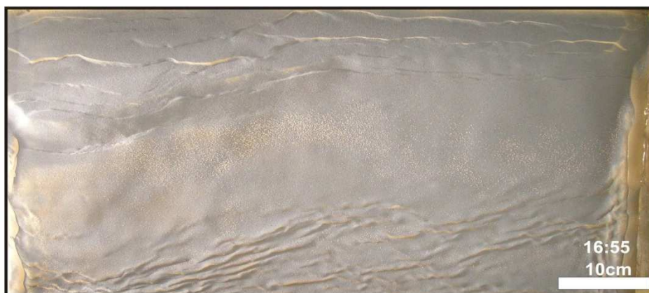
Figura 28: conjunto de fotografia do experimento 2902 demonstrando a propagação das dobras sub-paralelas a falha de base do silicone.
