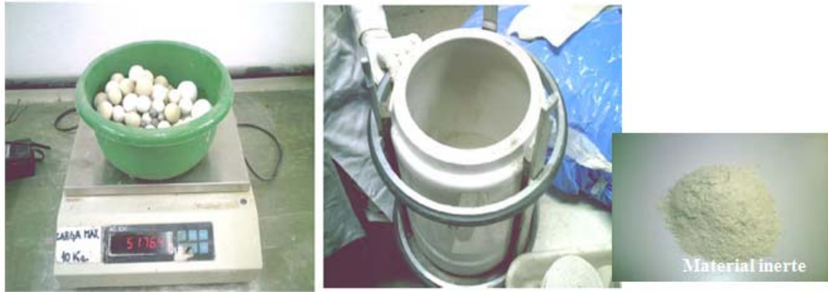
Figura 3.5: Bolas de Alumina e jarro com capacidade de 7,5Kg
