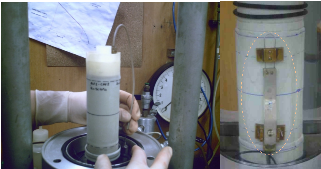
Figura 3.15: Sistema interno de medição de deformações axiais
