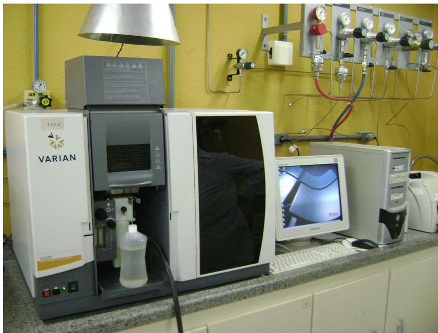
Figura 3.8. Espectrofotômetro de absorção atômica utilizado para a determinação dos minerais.
