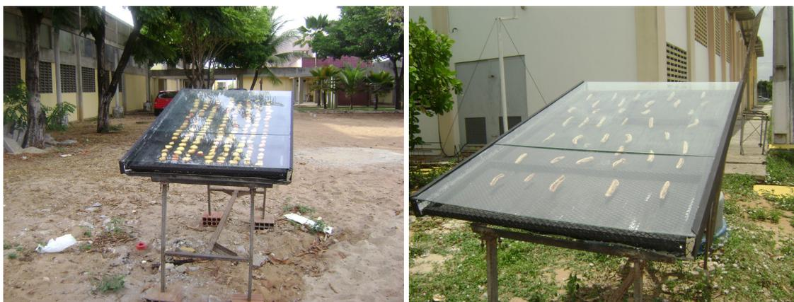
Figura 3.3. Secador solar construído em teste.
