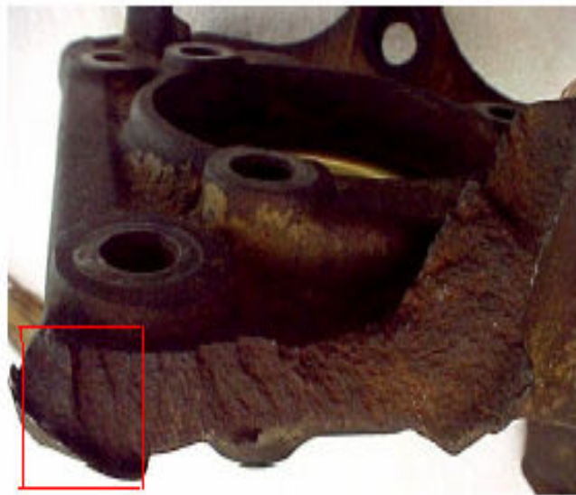
Figura 71 – Região onde foi retirada amostra na peça fraturada.
