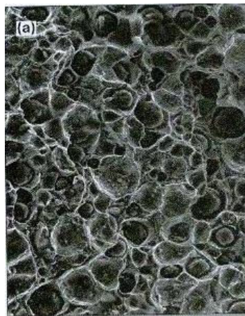
Figura 45 – Fratura de ferro fundido nodular tipo dúctil com coalescimento de cavidades.
