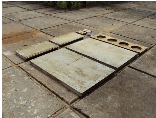
Figura 49. Molde de aço desmontado.
