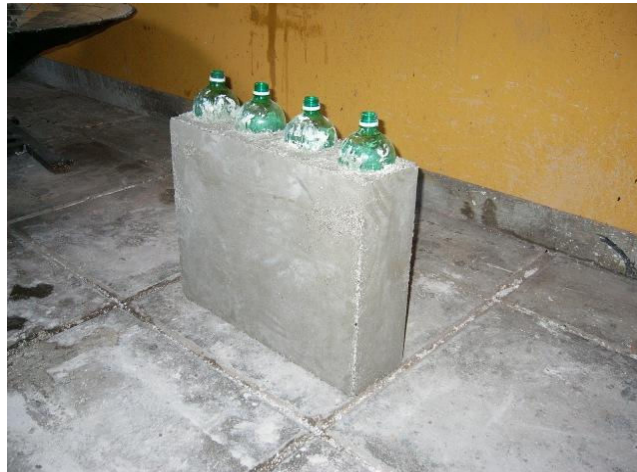
Figura 27: Bloco após desenformado e corte do fundo das garrafas inferiores.
