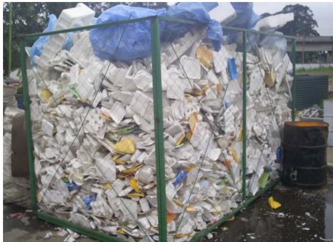
Figura 13. Embalagens de EPS usadas como matéria prima para produção do compósito.
