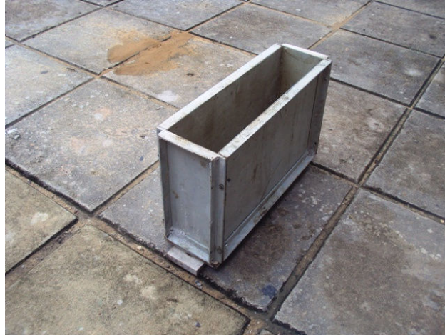
Figura 48. Molde de aço confeccionado para substituir o de madeira.
