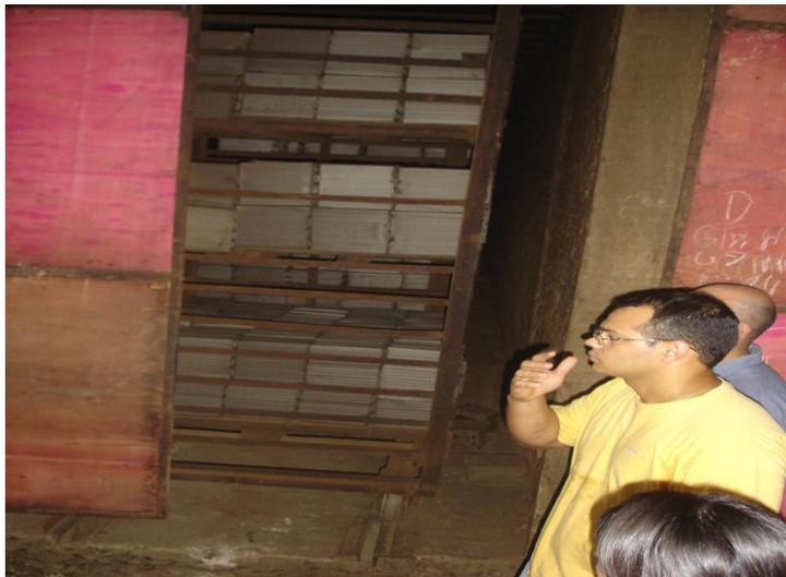
(a) Vagonete no túnel para secagem forçada
