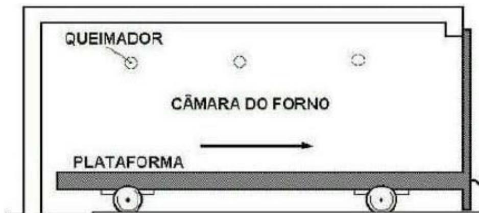
Figura 27 – Forno do tipo plataforma
