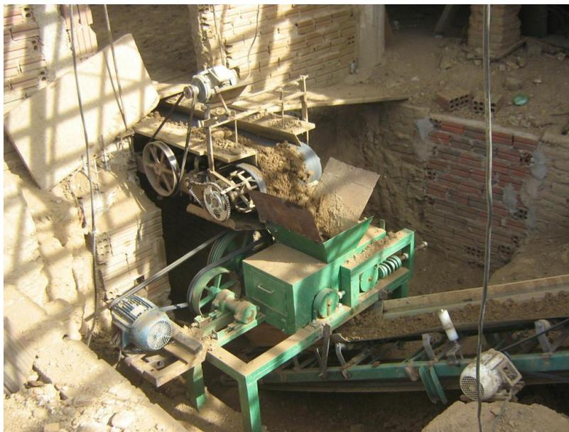
Figura 46 – Desintegrador
