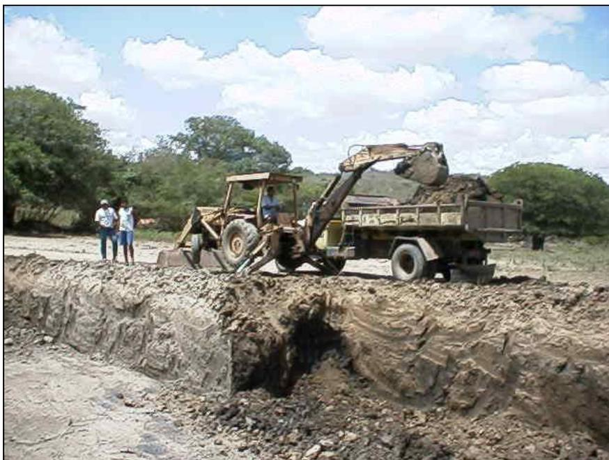
Figura 4 – Retroscavadeira processo de extração
