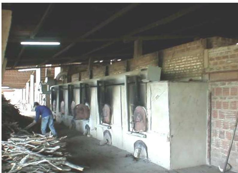
Figura 24 – Forno tipo Túnel é o mais eficiente
