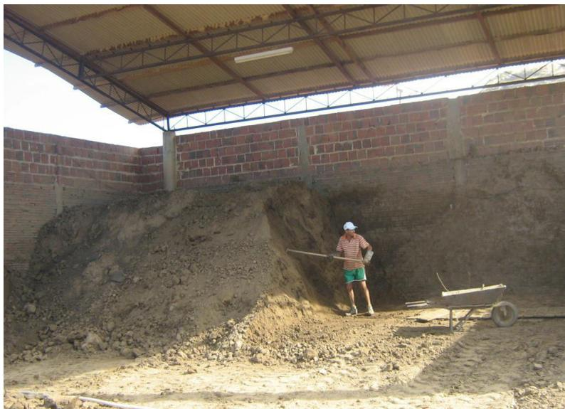
Figura 45 – Caixão alimentador manual esteirão
