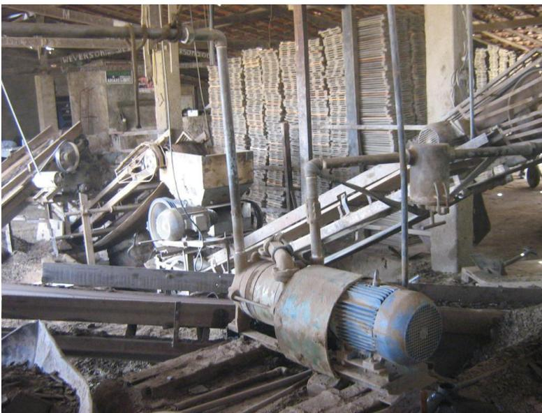
Figura 50 – Bomba de Vácuo
