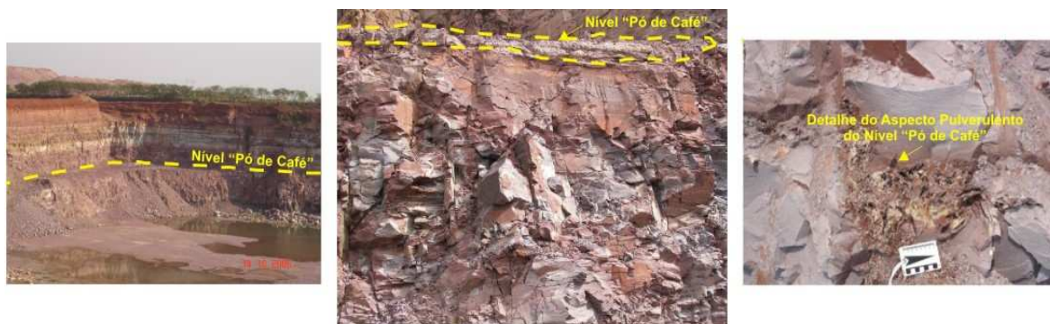
Figura 31: Visão Geral da Frente de Lavra da Mina Granusso, com destaque para a ocorrência do Nível “Pó de Café”.
