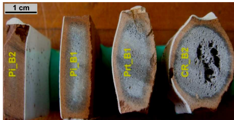
Figura 2: Corte de Corpos de Prova de amostras caracterizadas, mostrando diferentes graus de “coração negro” (ROCHA et al., 2008).
